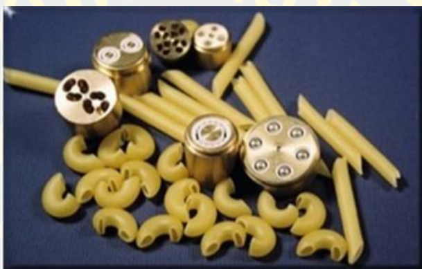
ภาพที่ 2-14 หน้าแปลน (die) ของเครื่องเอกซ์ทรูเดอร์สำหรับการผลิตพาสตา ที่มา: มหาวิทยาลัยหอการค้าไทย (2561)
