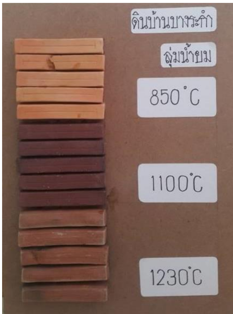
ภาพที่ 4-54 แท่งทดลองการทดสอบสมบัติกายภาพดินบ้านบางระกำ
