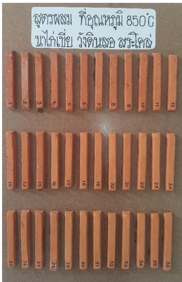
ภาพที่ 4-60 ผลการทดลองการนำดินจาก 3 แหล่งมาทำการผสมกัน เพื่อหาสูตรเนื้อดินปั้นใหม่ โดยใช้วิธีการไขว้สูตร จากตารางสามเหลี่ยม นำดินทั้งสามแหล่งมาเข้าสูตรจะได้ทั้งหมด 36 สูตร
