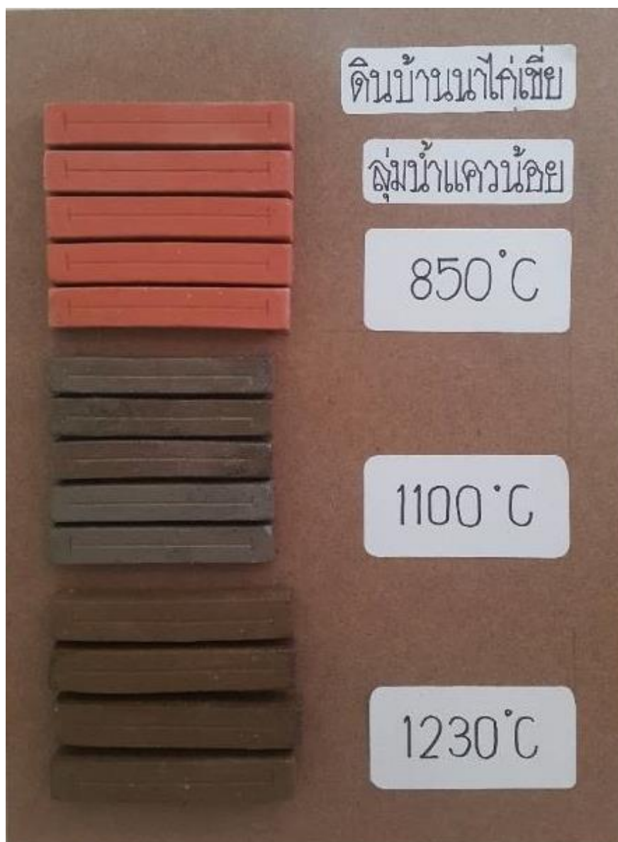
ภาพที่ 4-55 แท่งทดลองการทดสอบสมบัติกายภาพดินบ้านนาไก่เขียว
