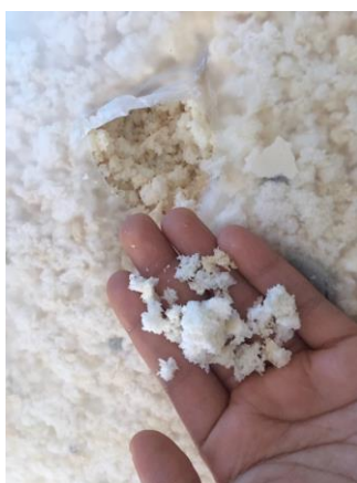
ภาพที่ 77 แสดงลักษณะของเศษยางพาราที่เหลือจากการขึ้นรูป
