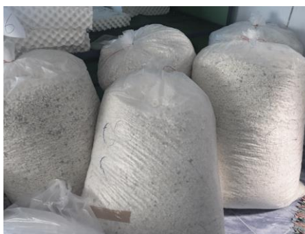
ภาพที่ 78 แสดงลักษณะของปริมาณเศษยางพาราที่เหลือจากการขึ้นรูป
