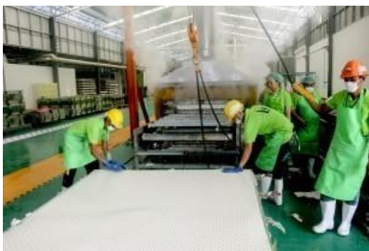
ภาพที่ 52 แสดงลักษณะการถอดผลิตภัณฑ์ออกจากแบบพิมพ์ (The Lion Kung Thailand, 2015)
