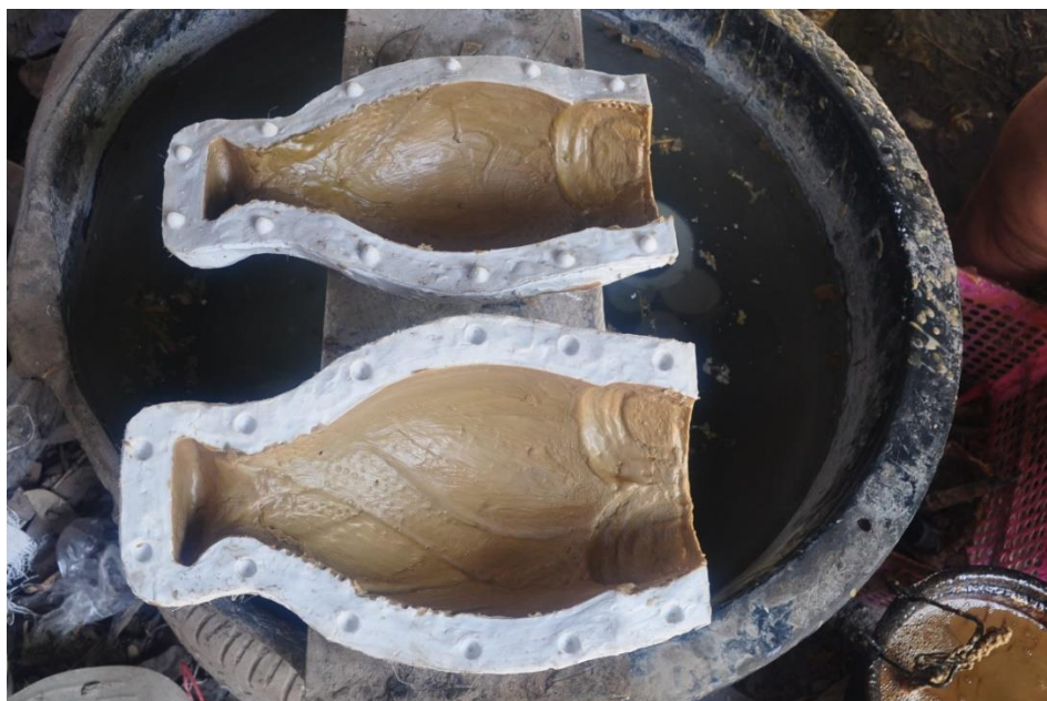
ภาพที่ 4 - 73 ขั้นตอนการฝังพิมพ์หลังทำการทาจี้ผึ้ง ผลิตภัณฑ์ (ที่มา: ภาพประกอบ โดย อิชฎี รานอก)
