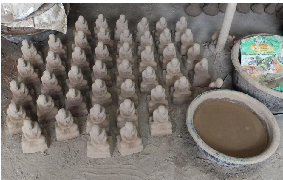
ภาพที่ 3 - 5 นำหุ่นจี๋ผึ้ง ที่แต่งเสร็จแล้ว ทาดินนวล (ที่มา: ภาพประกอบ โดย อิชฎ์ รานอก)
