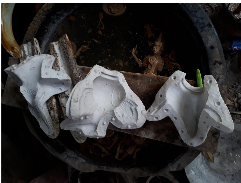
ภาพที่ 4 - 56 ขั้นตอนแกะพิมพ์ดินแบบดิน ผลิตภัณฑ์เชิงเทียน (ที่มา: ภาพประกอบ โดย อิชฎี รานอก)
