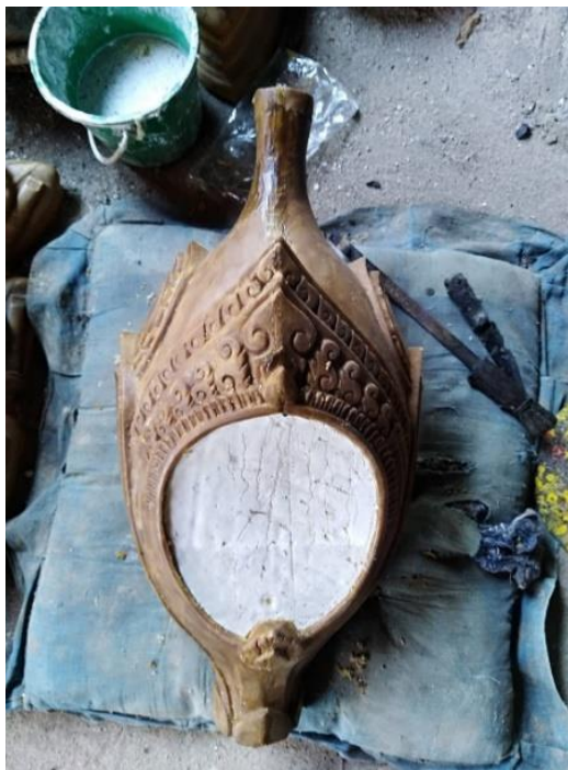
ภาพที่ 4 - 78 ภาพแสดงต้นแบบขี้ผึ้ง เทแกนปูนปลาสเตอร์ภายใน ผลิตภัณฑ์โคมไฟ (ที่มา: ภาพประกอบ โดย อิชฎ์ รานอก)
