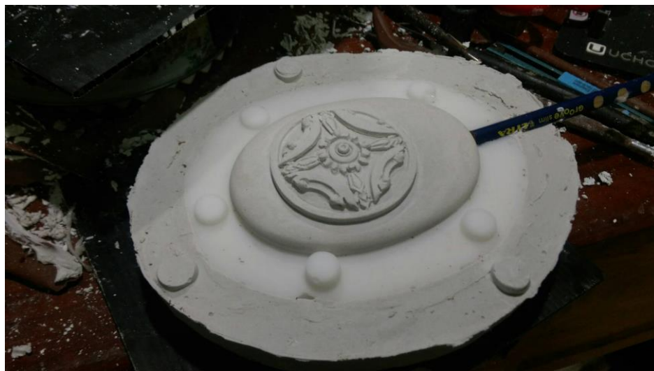
ภาพที่ 4 - 68 ขั้นตอนการแกะพิมพ์ปูนปลาสเตอร์ ผลิตภัณฑ์เครื่องแขวน ลูกกระดิ่ง (ที่มา: ภาพประกอบ โดย อิชฎี รานอก)
