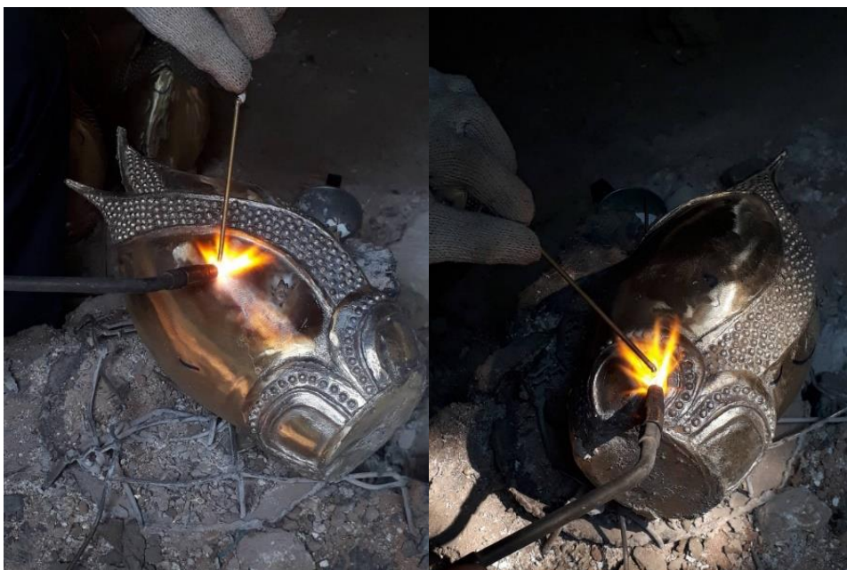
ภาพที่ 4 - 97 ขั้นตอนการปิดรูปพูนหรือตำหนิแล้วนำไปขัดแต่งผลิตภัณฑ์ทองเหลือง อีกครั้ง (ที่มา: ภาพประกอบ โดย อิชฎี รานอก)
