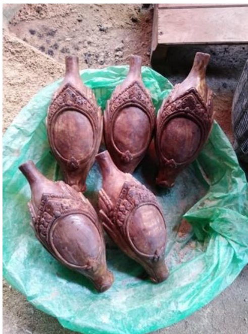
ภาพที่ 4 - 79 ภาพแสดงต้นแบบขี้ผึ้ง ผลิตภัณฑ์โคมไฟ (ที่มา: ภาพประกอบ โดย อิชฎ์ รานอก)
