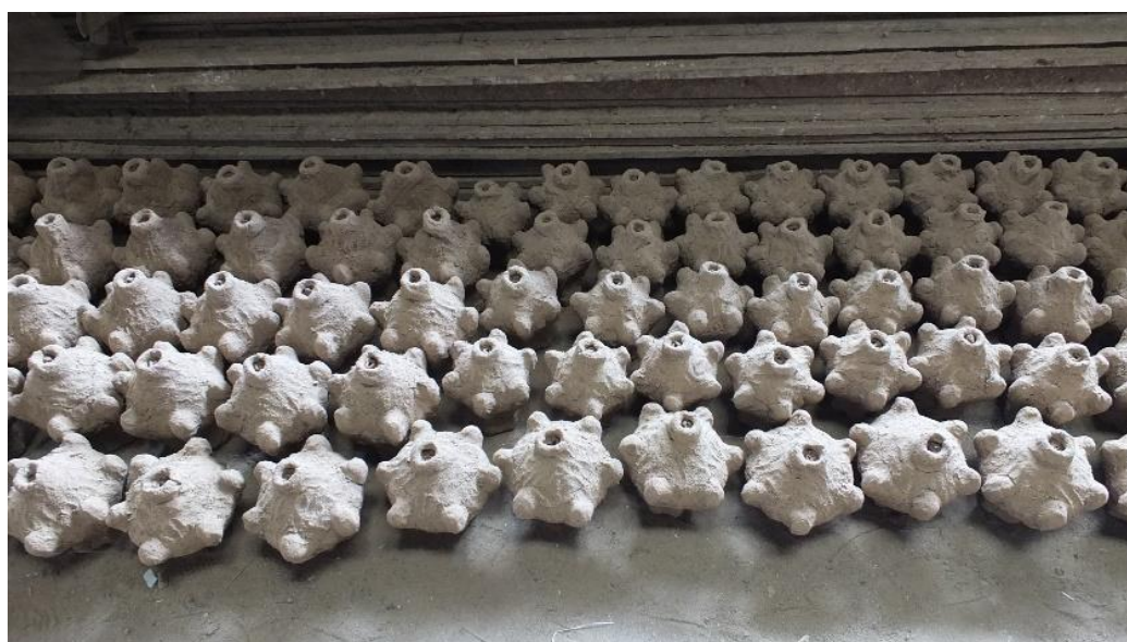
ภาพที่ 3 - 9 นำชิ้นงานมาเคียนลวดและพอกดินทิ้งไว้แห้งอย่างน้อย 2 วัน (ที่มา: ภาพประกอบ โดย อิชฎ์ รานอก)
