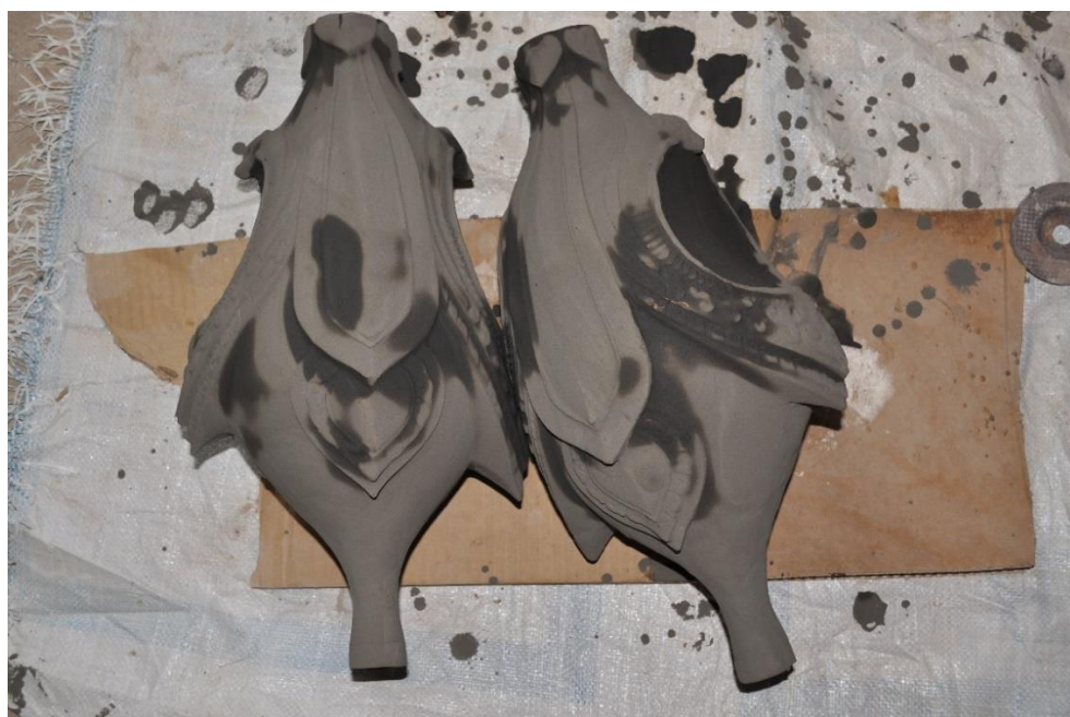
ภาพที่ 4 - 87 ขั้นตอนการเข้าดิน ตัวอย่างผลิตภัณฑ์โคมไฟ (ที่มา: ภาพประกอบ โดย อิชฎี รานอก)
