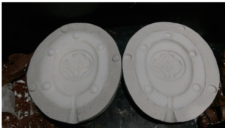
ภาพที่ 4 - 69 ขั้นตอนการแกะพิมพ์ปูนปลาสเตอร์ทั้งสองข้าง ผลิตภัณฑ์เครื่องแขวน ลูกกระดิ่ง (ที่มา: ภาพประกอบ โดย อิชฎี รานอก)
