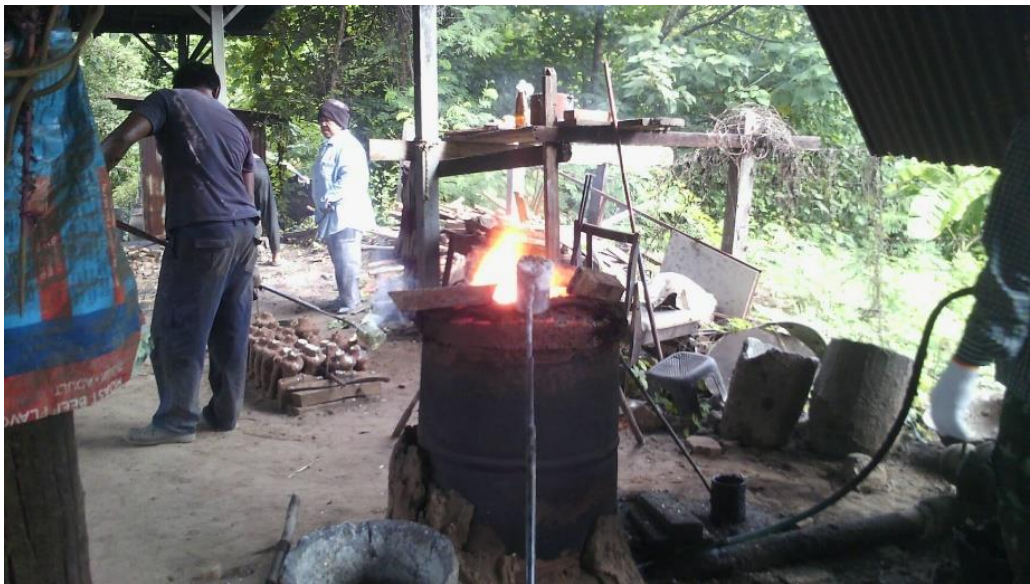
ภาพที่ 3 - 11 การเผาทองเหลือง (ที่มา: ภาพประกอบ โดย อิชฎ์ รานอก)
