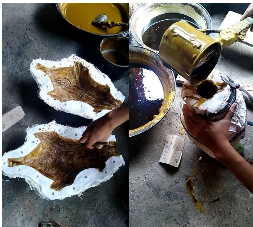
ภาพที่ 4 - 74 ขั้นตอนการทำการทาจี้ผึ้งและกรอกจี้ผึ้ง ผลิตภัณฑ์โคมไฟ (ที่มา: ภาพประกอบ โดย อิชฎี รานอก)
