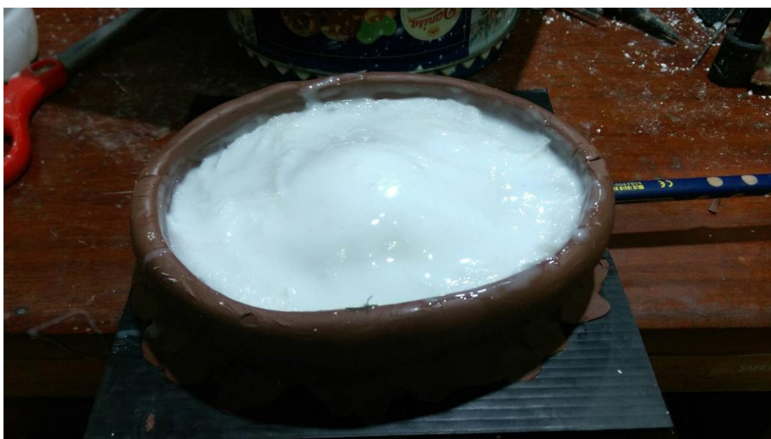
ภาพที่ 4 - 67 ขั้นตอนพอกขางพาราและพอกปูน ผลิตภัณฑ์เครื่องแขวน ลูกกระดิ่ง (ที่มา: ภาพประกอบ โดย อิชฎ์ รานอก)
