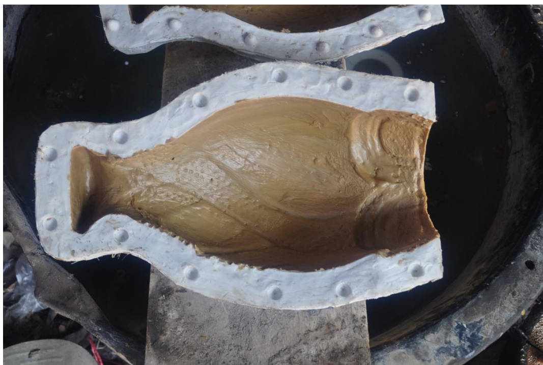
ภาพที่ 4 - 72 ขั้นตอนการทำกรทำจี๊ตติ้ง ผลิตภัณฑ์แจกัน (ที่มา: ภาพประกอบ โดย อิชฎี รานอก)
