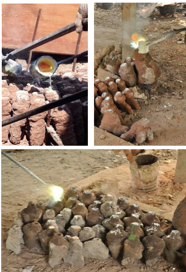
ภาพที่ 4 - 94 ขั้นตอนการเททอง (ที่มา: ภาพประกอบ โดย อิชฎี รานอก)
