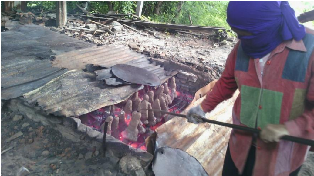
ภาพที่ 3 - 10 การเผาชิ้นงานก่อนเททอง (ที่มา: ภาพประกอบ โดย อิชฎ์ รานอก)
