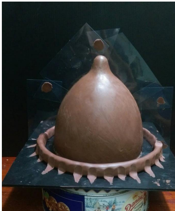
ภาพที่ 4 - 54 ขั้นตอนการกั้นพิมพ์ดินแบบดินผลิตภัณฑ์เครื่องเขวนประเภทกระดิ่ง (ที่มา: ภาพประกอบ โดย อิชฎี รานอก)
