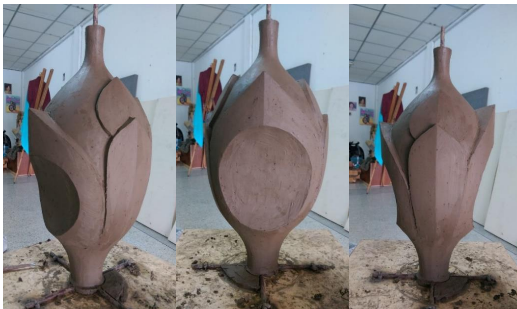
ภาพที่ 4 - 46 ขั้นตอนการจัดทำต้นแบบดินผลิตภัณฑ์โคมไฟ (ที่มา: ภาพประกอบ โดย อิชฎี รานอก)
