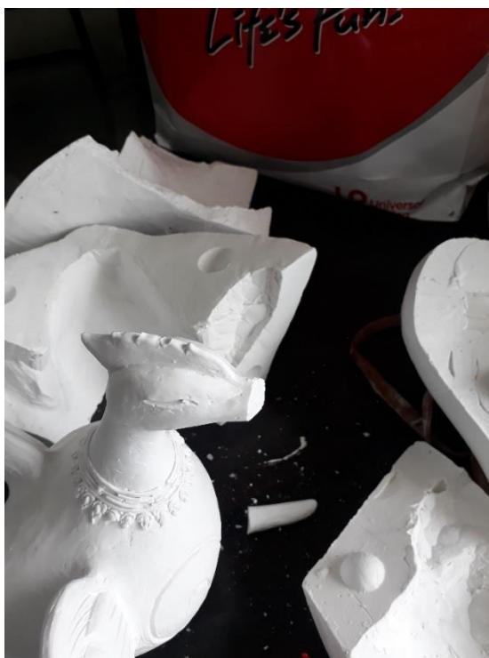
ภาพที่ 4 - 71 ขั้นตอนการแกะพิมพ์ปูนปลาสเตอร์ และยางพารา ผลิตภัณฑ์เชิงเทียน (ที่มา: ภาพประกอบ โดย อิชฎ์ รานอก)
