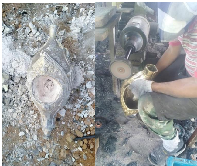
ภาพที่ 4 - 96 ขั้นตอนการขัดแต่งผลิตภัณฑ์ทองเหลืองที่ทำการหล่อแล้ว (ที่มา: ภาพประกอบ โดย อิชฎ์ รานอก)
