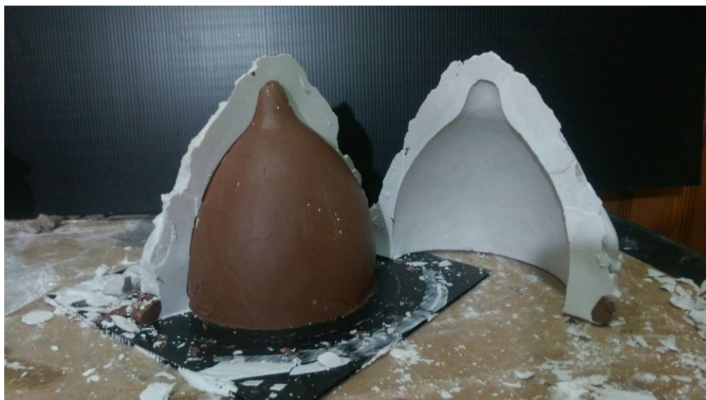
ภาพที่ 4 - 55 ขั้นตอนแกะพิมพ์ดินแบบดิน ผลิตภัณฑ์เครื่องเขนประเภทกระดิ่ง (ที่มา: ภาพประกอบ โดย อิชฎี รานอก)
