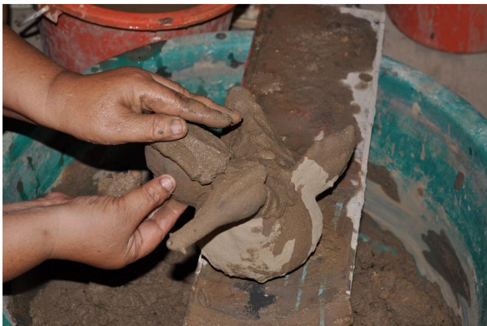
ภาพที่ 4 - 90 ขั้นตอนการเข้าดิน แบบพอกหน้า (ที่มา: ภาพประกอบ โดย อิชฎี รานอก)
