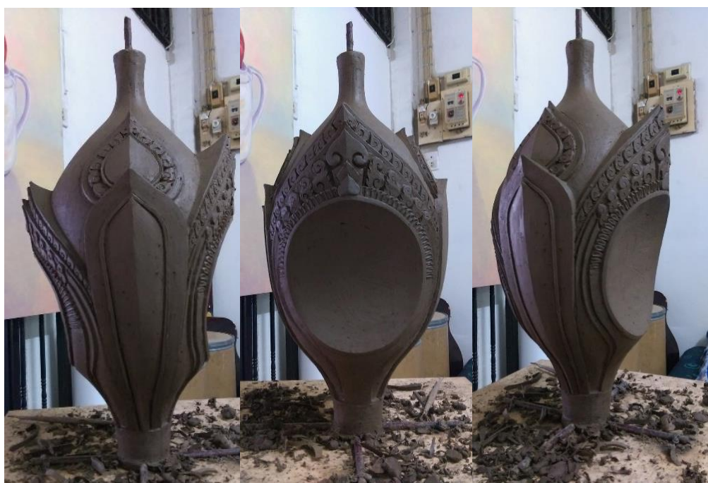
ภาพที่ 4 - 47 ขั้นตอนการแกะลวดลายต้นแบบดินผลิตภัณฑ์โคมไฟ แกะลวดลายกลีบบัว (ที่มา: ภาพประกอบ โดย อิชฎี รานอก)
