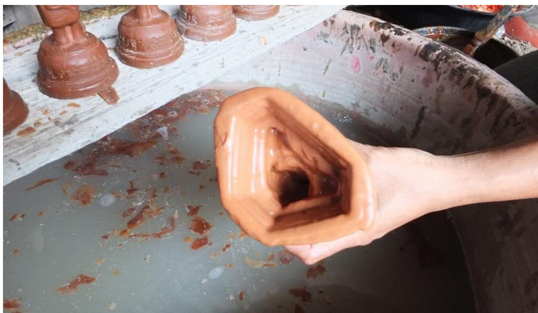
ภาพที่ 3 - 3 กรอกสีผึ้งลงในแบบพิมพ์หลายๆ ครั้งจนได้ความหนาที่เพียงพอ (ที่มา: ภาพประกอบ โดย อิชฎี รานอก)
