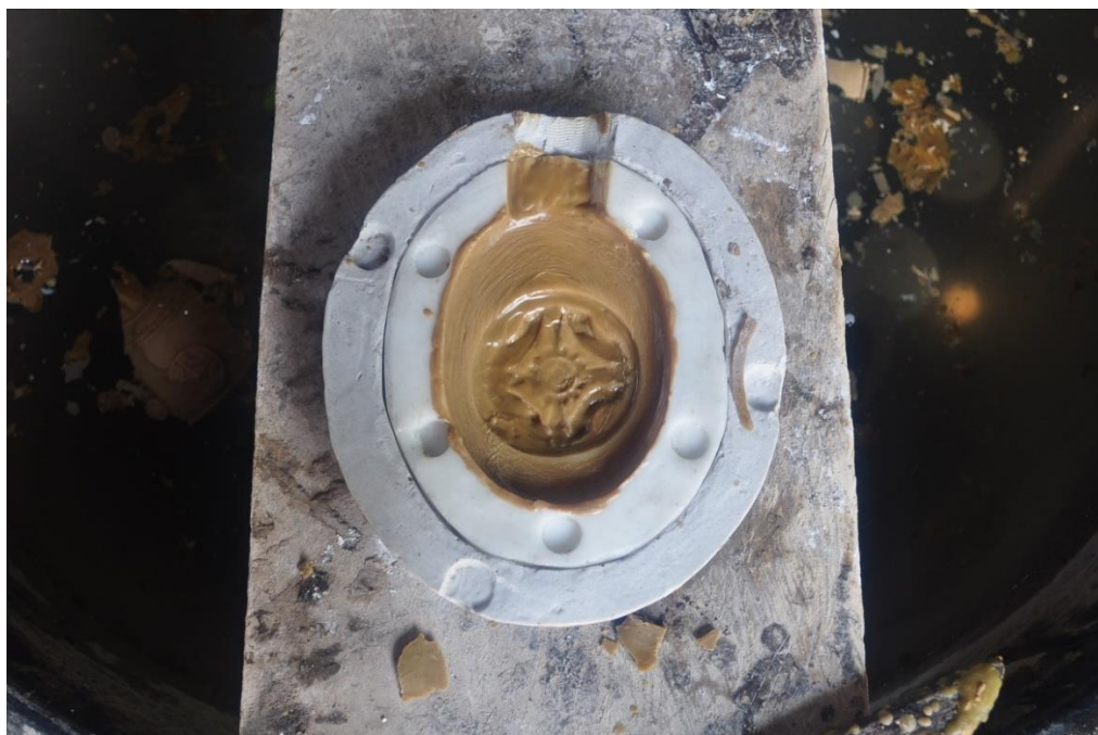
ภาพที่ 4 - 75 ขั้นตอนการทำการทาสีผึ้ง ผลิตภัณฑ์เครื่องแขวน ลูกกระดิ่ง (ที่มา: ภาพประกอบ โดย อิชฎี รานอก)
