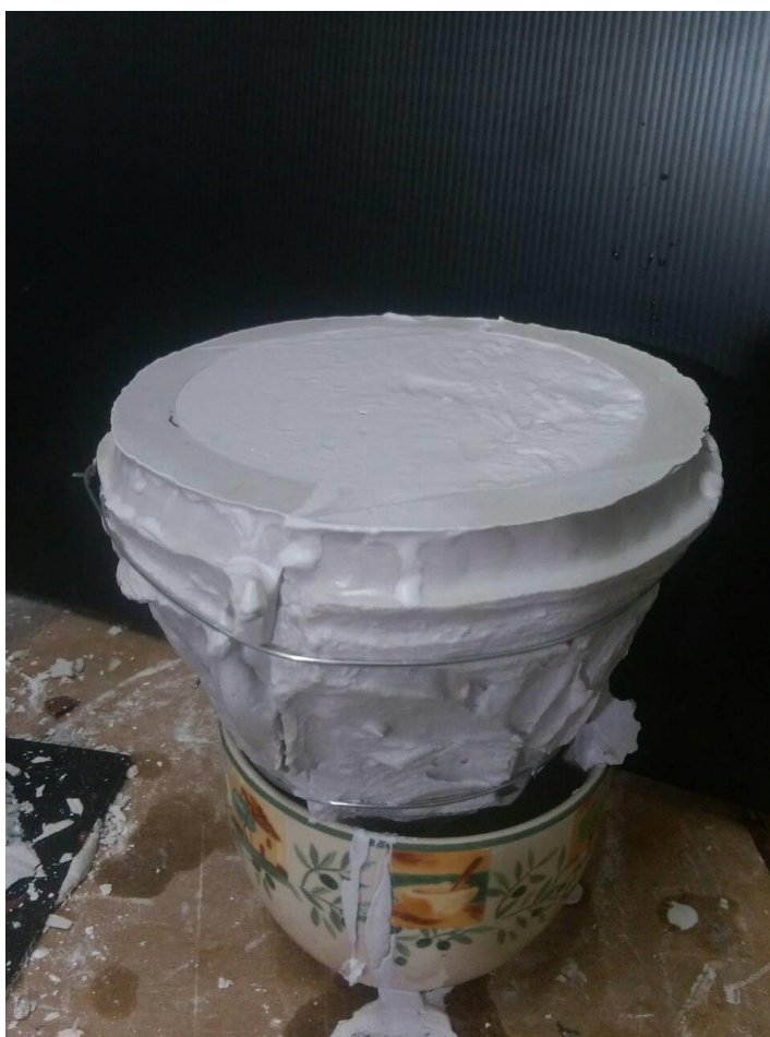
ภาพที่ 4 - 57 ขั้นตอนแกะพิมพ์ต้นแบบปูน ผลิตภัณฑ์เครื่องแขวนประเภทกระดิ่ง (ที่มา: ภาพประกอบ โดย อิชฎี รานอก)
