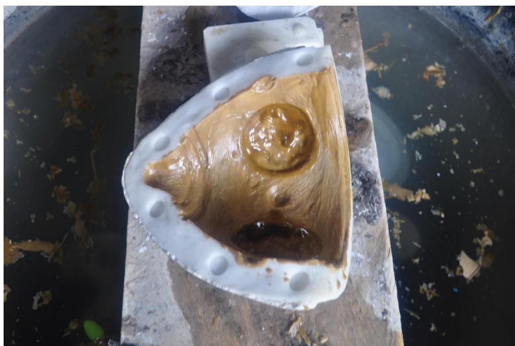
ภาพที่ 4 - 76 ขั้นตอนการทำการทาสีผึ้ง ผลิตภัณฑ์เครื่องแขวน ตัวกระดิ่ง (ที่มา: ภาพประกอบ โดย อิชฎี รานอก)
