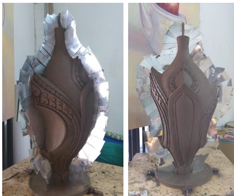
ภาพที่ 4 - 53 ขั้นตอนการกั้นพิมพ์ต้นแบบดินผลิตภัณฑ์โคมไฟ (ที่มา: ภาพประกอบ โดย อิชฎี รานอก)
