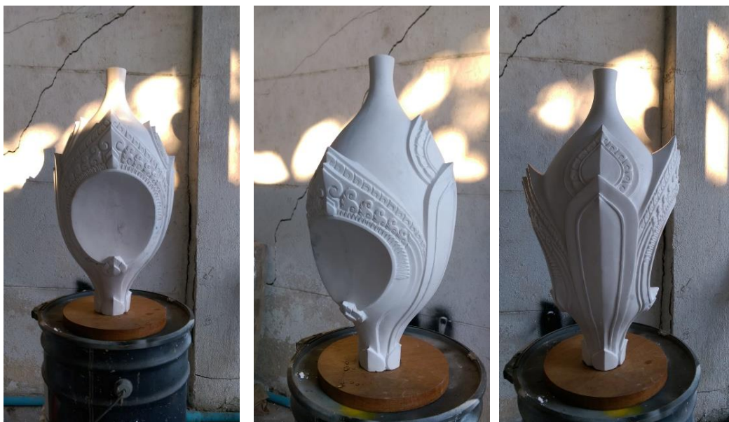
ภาพที่ 4 - 58 ขั้นตอนการทำต้นแบบปูนปลาสเตอร์ผลิตภัณฑ์โคมไฟ (ที่มา: ภาพประกอบ โดย อิชฎ์ รานอก)
