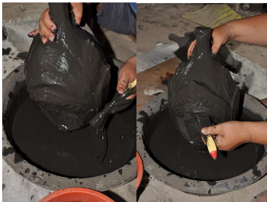
ภาพที่ 4 - 88 ขั้นตอนการเข้าดิน การใช้แปรงค่อยทาดิน (ที่มา: ภาพประกอบ โดย อิชฎี รานอก)
