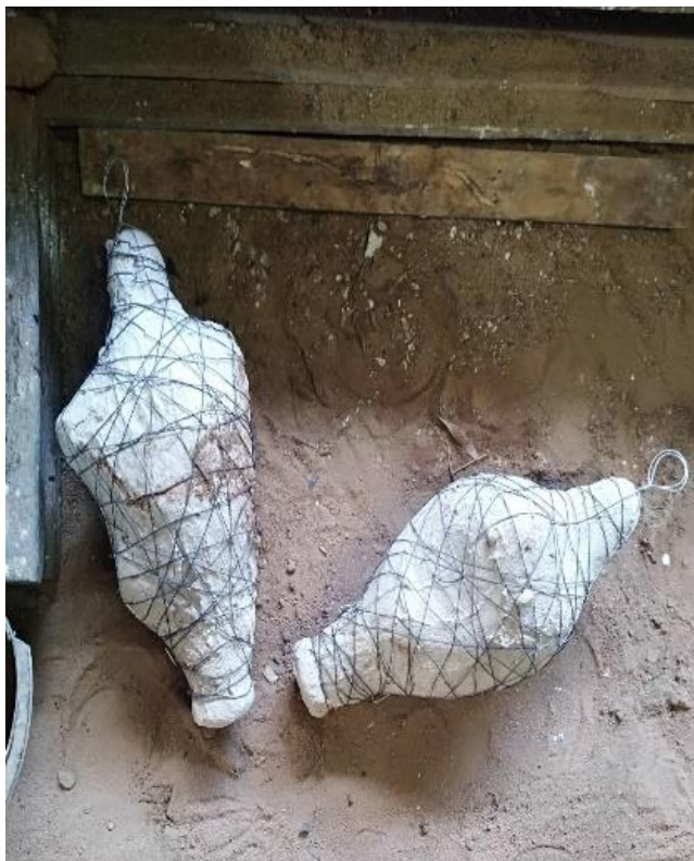
ภาพที่ 4 - 85 ขั้นตอนการพันลวด ตัวอย่างผลิตภัณฑ์โคมไฟ (ที่มา: ภาพประกอบ โดย อิชฎี รัตนอก)
