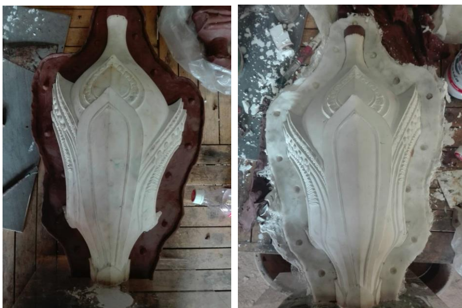
ภาพที่ 4 - 63 ขั้นตอนแบ่งพิมพ์เพื่อทำพิมพ์ยางพาราและพอกปูน ผลิตภัณฑ์โคมไฟ (ที่มา: ภาพประกอบ โดย อิชฎี รานอก)
