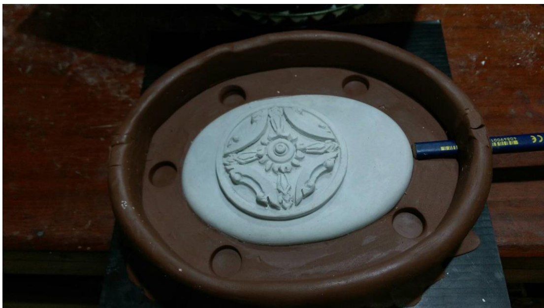
ภาพที่ 4 - 66 ขั้นตอนเตรียมการพอกขางพาราและพอกปูน ผลิตภัณฑ์เครื่องแขวน ลูกกระดิ่ง (ที่มา: ภาพประกอบ โดย อิชฎ์ รานอก)
