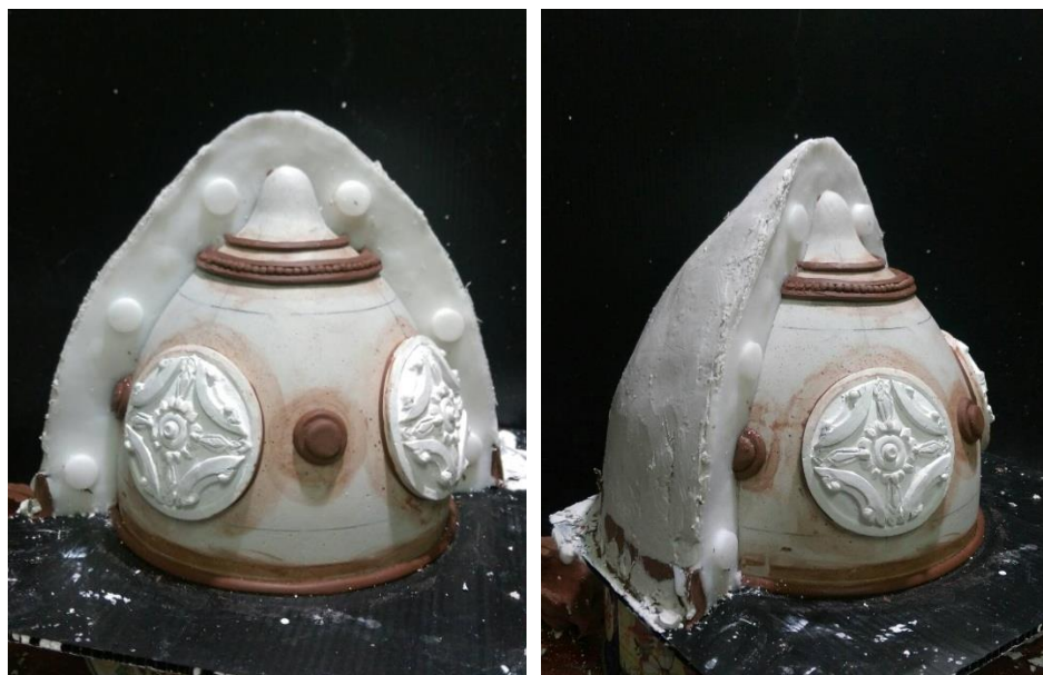
ภาพที่ 4 - 70 ขั้นตอนการแกะพิมพ์ปูนปลาสเตอร์ และยางพารา ผลิตภัณฑ์เครื่องเขวน (ที่มา: ภาพประกอบ โดย อิชฎ์ รานอก)
