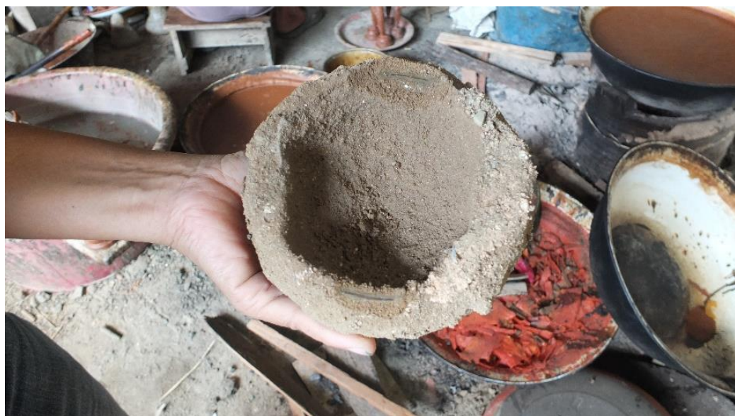
ภาพที่ 3 - 7 นำหุ่นขี้ผึ้งที่ทำดินนวลแล้วพอกด้วยดินทรายผสมดินปลวกด้านในหุ่น (ที่มา: ภาพประกอบ โดย อิชฎี รานอก)
