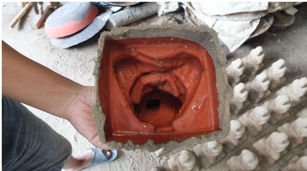
ภาพที่ 3 - 6 นำหุ่นขี้ผึ้งที่ทำดินนวลแล้วพอกด้วยดินทรายผสมดินปลวกภายนอกหุ่น (ที่มา: ภาพประกอบ โดย อิชฎี รานอก)
