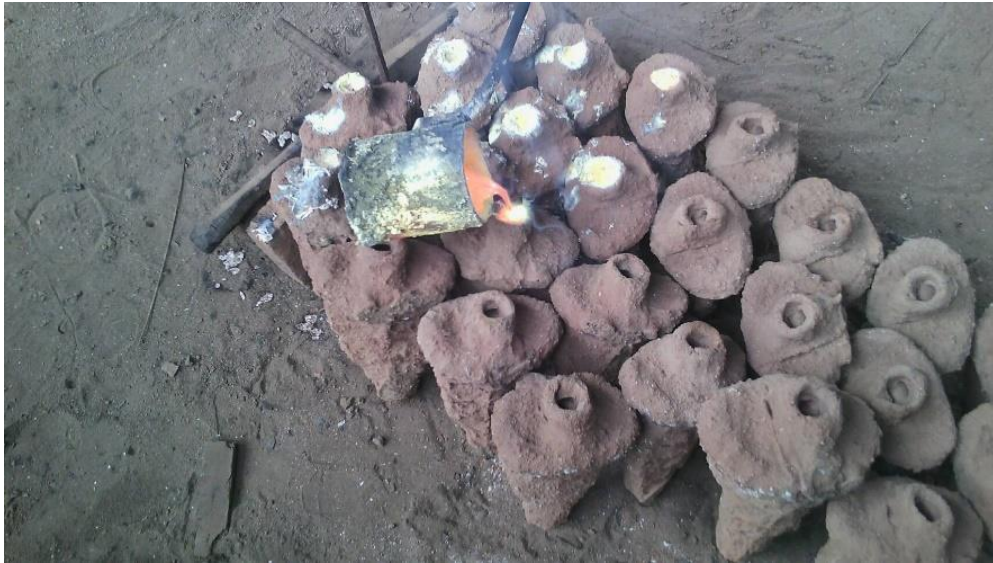
ภาพที่ 3 - 12 การเททองเหลือง (ที่มา: ภาพประกอบ โดย อิชฎี รานอก)
