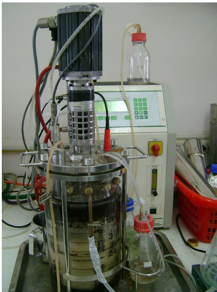
ภาพที่ 5 การจัดเตรียมถังหมักขนาด 5 ลิตร สำหรับเพาะเลี้ยงแบบกะ
