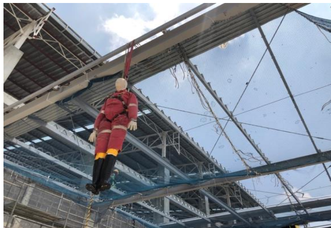
ภาพที่ 19 การทดสอบระบบขยับยั้งการตกส่วนบุคคลหลังการปรับปรุง
