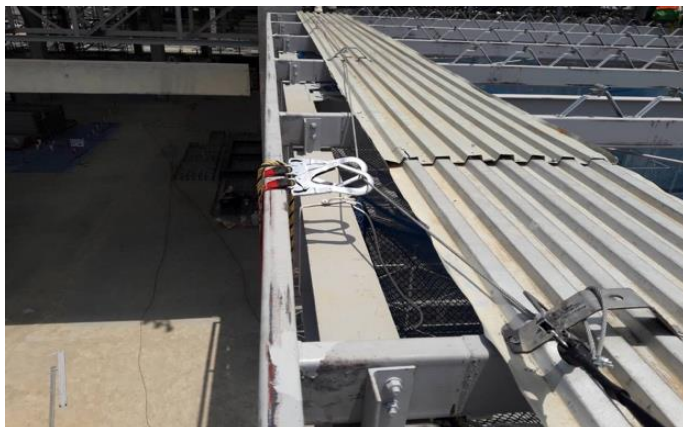
ภาพที่ 20 สภาพของระบบขั้วยั้งการตกส่วนบุคคลหลังการทดสอบ
