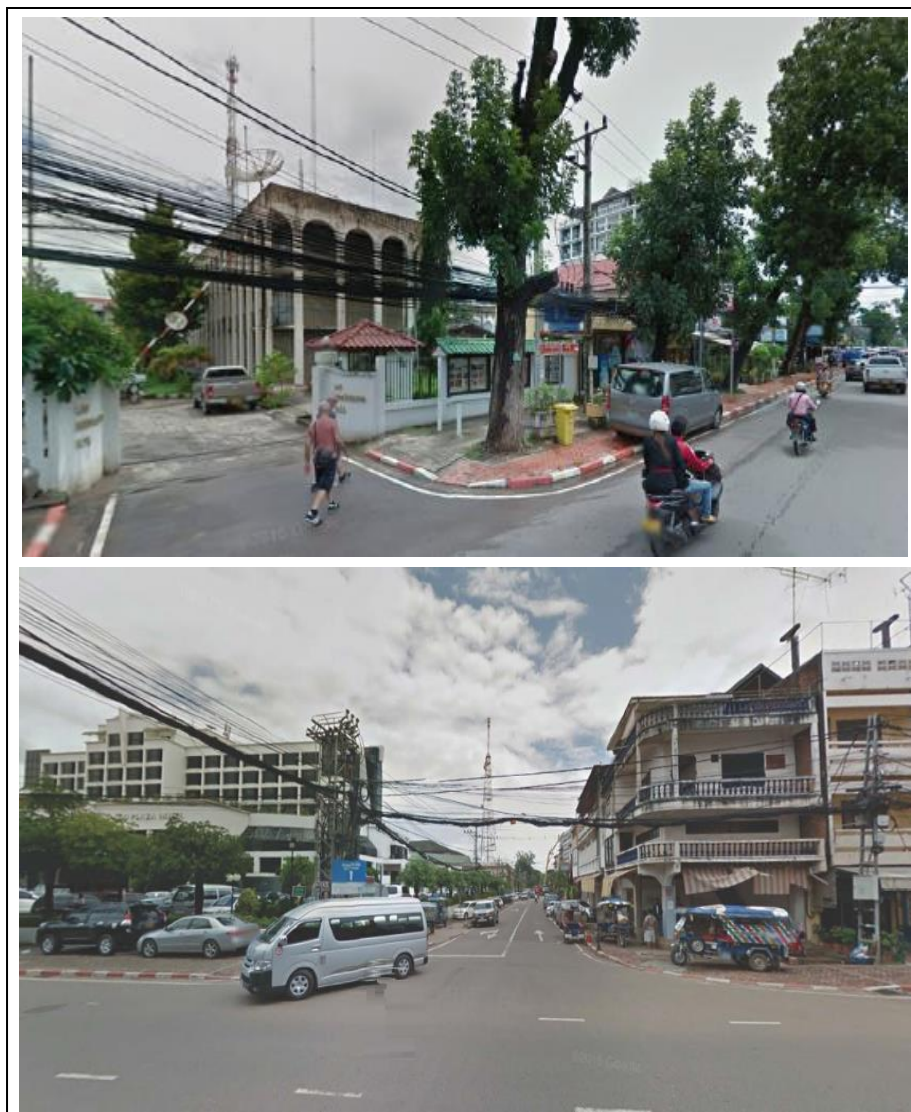
ภาพที่ 4-8 ปัญหาสำคัญเร่งด่วนที่มีความเสี่ยงต่อความปลอดภัยในชีวิตและทรัพย์สินของประชาชน ที่ได้สำรวจพบในเขตพื้นที่ของโครงการที่มีการติดตั้งสายสื่อสารพาดผ่านหม้อแปลงไฟฟ้าแรงสูง บริเวณหน้าสำนักงานลาวนิว (Lao News) และ โรงแรมลาวพลาซ่า (Lao Plaza hotel)
