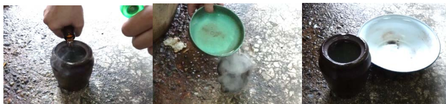
ภาพที่ 5-47 ขั้นตอนการผสมกรดกำมะถันกับน้ำเพื่อลดความหนืดของกำมะถัน สัดส่วน 1 : 1
