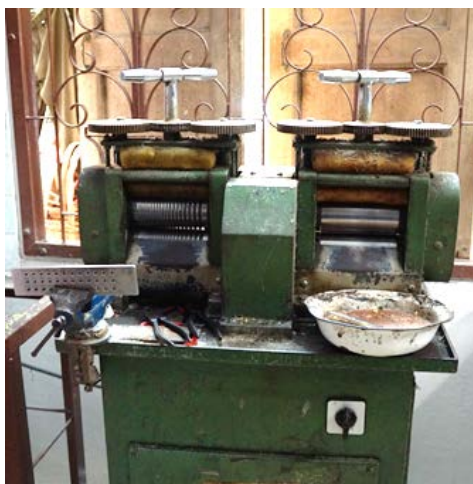
ภาพที่ 5-12 เครื่องรีดทองระบบไฟฟ้า ของร้านทองรุ่งสีทอง (แม่เกี้ยว) มีแป้นรีด 2 แบบ ใน เครื่องเดียวกัน คือ แป้นรีดทองเป็นแบบแท่ง และ แป้นรีดทองเป็นแผ่นแบน
