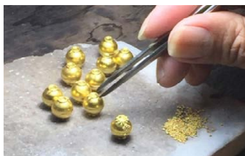
ภาพที่ 5-34 ลูกประดับทรงกลม ขึ้นรูปจากเบ้าแบบทอง
