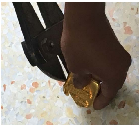
ภาพที่ 5-26 ช่างทองขณะใช้คีมตัดแบ่งทองคำแท่งตามน้ำหนักที่ต้องการ
