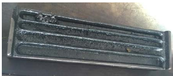
ภาพที่ 5-8 รางหลอมทองทำจากเหล็ก
