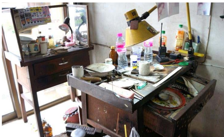
ภาพที่ 5-4 โต๊ะทำทองของช่างทองร้านรุ่งสีทอง แบบมีลิ้นชัก 2 ลิ้นชัก โต๊ะตัวหน้า มีกระจกใส สำหรับบังลม 3 ด้าน
