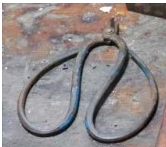
ภาพที่ 5-21 กรรไกรตัดทอง ลักษณะเป็นกรรไกรเหล็ก ใบบิดของกรรไกรสั้น มีหูกรรไกรขนาดใหญ่สามารถจับได้ถนัดกว่ากรรไกรทั่วไป
