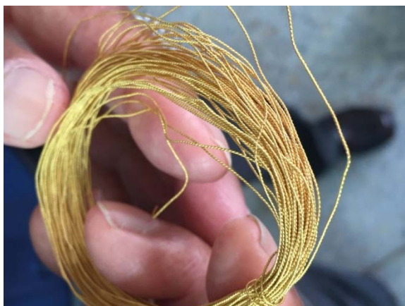
ภาพที่ 5-29 เส้นลวดทองแบบบิดเกลียว
