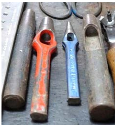
ภาพที่ 5-19 เหล็กคู้ดคู่หลายขนาดลักษณะคล้ายตาไก่ ใช้สำหรับตอกแผ่นทองออกเป็นขนาดต่าง ๆ
