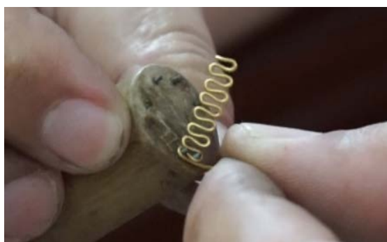
ภาพที่ 5-32 ช่างปียะณัฐ รุ่งสีทอง แสดงการตัดลวดด้วยไม้ตัดดอกไม้ประยุกต์ขึ้นเอง
