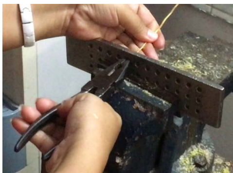
ภาพที่ 5-17 ช่างสัมพันธ์ ขณะใช้คีมดึงปลายลวดทองจากรูแป้นชักลวด
