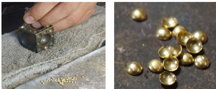
ภาพที่ 5-33 ช่างทองขณะขึ้นรูปแผ่นทองจากเบ้าแบบ และ ภาพขยายของแผ่นทองทรงครึ่งวงกลม
