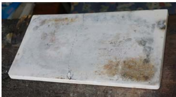
ภาพที่ 5-6 กระดานทนไฟ สำหรับรองรับชิ้นงานทองจากการเป่าเล่น
