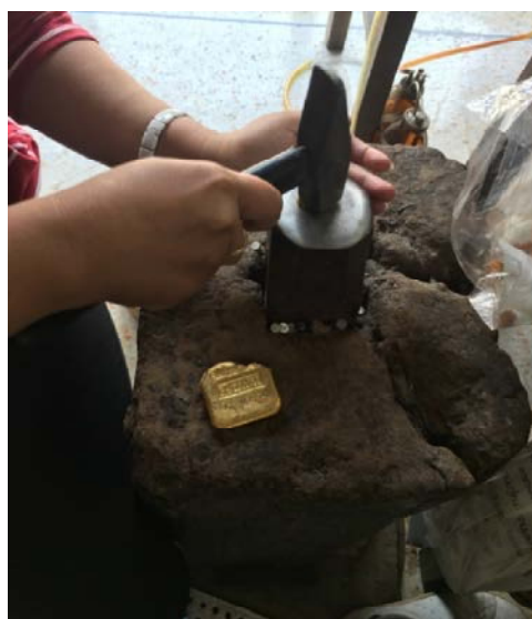
ภาพที่ 5-10 ช่างสัมพันธ์ ชนชาติทองด้วยค้อนบนทัง
