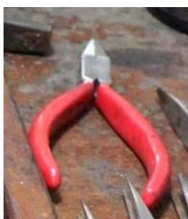
ภาพที่ 5-22 คีมตัด มีหลายขนาด ปากคีมด้านข้างมีลักษณะเป็นคมตัด ใช้สำหรับตัดชิ้นงานทองที่มีความแข็งและหนา เช่น ห่วง หลอด ฯลฯ
