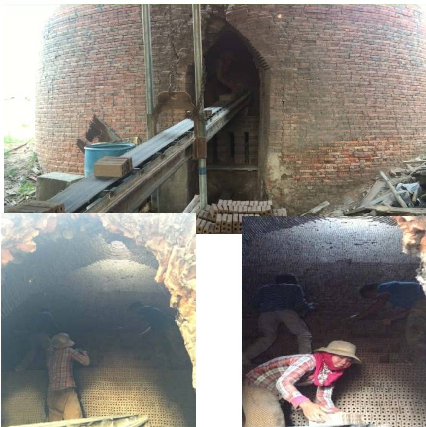
ภาพที่ 4-27 ขั้นตอนการลำเลียงอิฐและการจัดเรียงอิฐภายในเตาเผา
