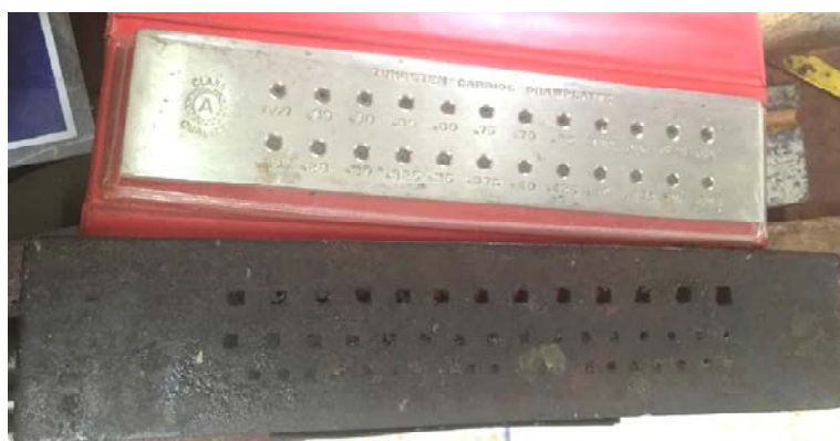
ภาพที่ 5-14 แป้นชักลวดแบบรูสี่เหลี่ยม เปรียบเทียบกันระหว่างแป้นชักลวดทั้งสแตนกับแป้นชักลวดเหล็ก
