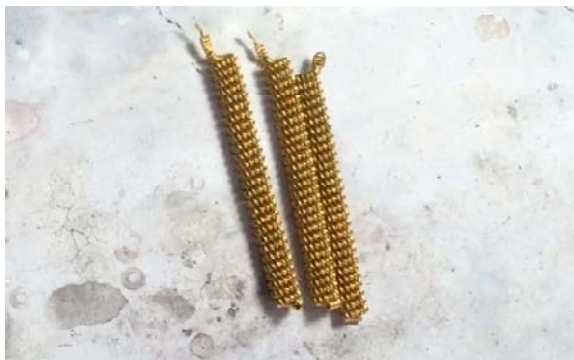
ภาพที่ 5-28 ลวดทองลักษณะคล้ายสปริง ได้จากการพันลวดทอง 2 ครั้ง
