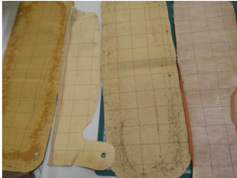
ภาพที่ 20 กระเป๋ายี่เป็ดผ่านการตัดแต่ง แยกชิ้นส่วนและขีดเส้น
