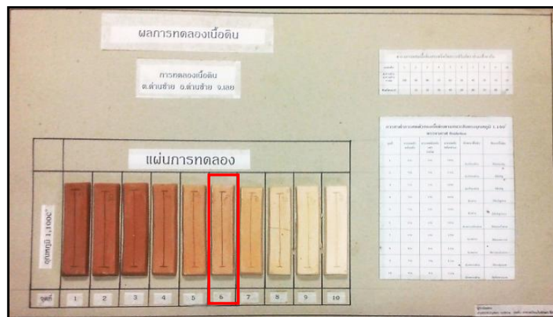
ภาพที่ 36 การทดลองลักษณะและสีของเนื้อดินหลังเผา 1,100 องศาเซลเซียส
