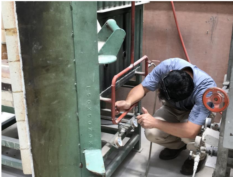
ภาพที่ ๔๔ การจุดไฟเตาแก๊ส เผาเคลือบไฟสูง
