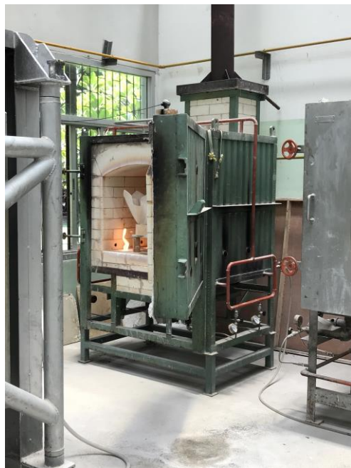
ภาพที่ ๔๕ เตาแก๊สที่ใช้ในการเผาเคลือบผลงาน
