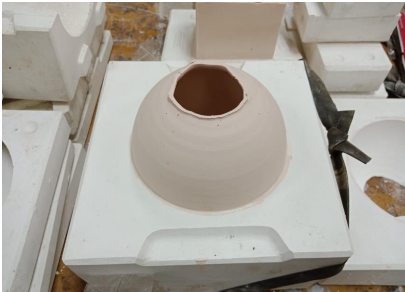
ภาพที่ ๑๖ ภาพหล่อน้ำดิน (บน) และถอดพิมพ์หลังจากขึ้นรูปแล้ว (ล่าง)
