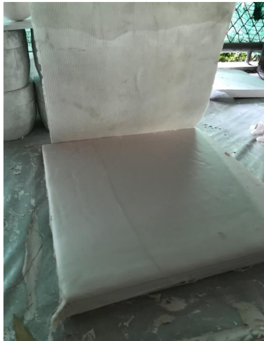
ภาพที่ ๓๘ การใช้แผ่นยางซิลิโคนอ่อน ลายเส้นประกบบนแผ่นดินที่ค่อนข้างหมาดแล้ว
