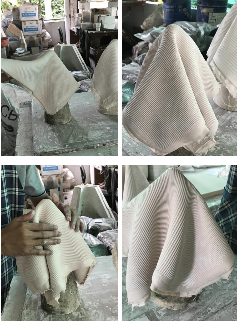
ภาพที่ ๔๐ การนำแผ่นดินที่มีผ้าอยู่ด้านล่าง วางห้อยลงบนแท่งปูนพลาสติก รูปทรงกรวยแหลม แล้วจัดตกแต่งเพื่อให้ได้รูปทรง
