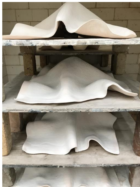
ภาพที่ ๔๖ ผลงานชุดที่ ๒ ที่วางเผาบนแผ่นพื้นในเตาเผา
