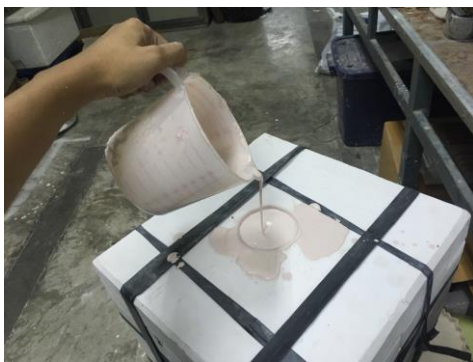
ภาพที่ ๒๗ ภาพร่าง ต้นแบบดิน พิมพ์ปูนปลาสเตอร์ การหล่อสลีป และการตกแต่ง ภาพหลังการหล่อ
