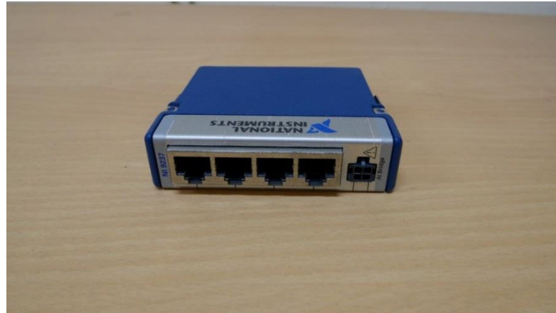
ภาพที่ 3-14 ชุดหน่วยแปลงสัญญาณ (Signal transformer module)
