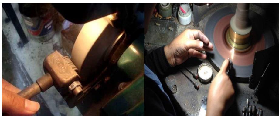
ภาพที่ 7 วิธีการโกนพลอยและเจียรระโนพลอยโดยใช้ฝีมือแรงงาน ที่ประณีต โดยอาศัยทักษะของ บุคคล
