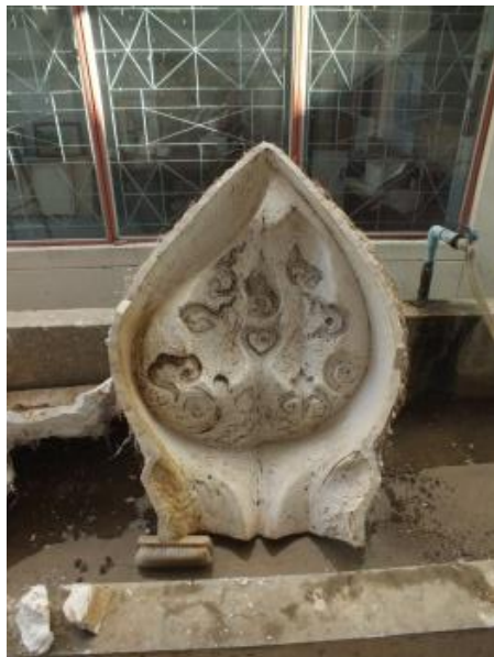
ภาพที่ ๓-๒๘ ขั้นตอนที่ ๔ การนำดินออกจากพิมพ์
