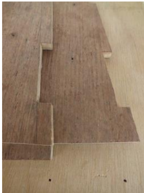
ภาพที่ ๓-๔๓ ขั้นตอนที่ ๒ การตัดแบบไม้ประกอบโครงสร้าง
