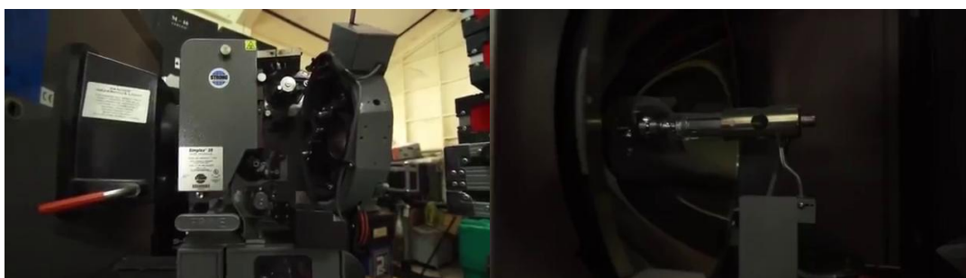
ภาพที่ ๔-๑๕ เครื่องฉายภาพยนตร์ระบบฟิล์ม ๓๕ มิลลิเมตร รูปแบบทำแสงด้วยหลอดซีนอล (ผู้วิจัย, ๒๕๕๘)
