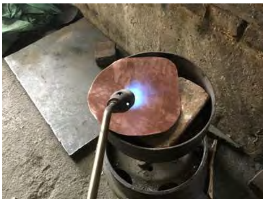
ภาพที่ 4-70 การลงไฟบนแผ่นโลหะ (ถ่ายโดย Zhang Linyi, 2018)
