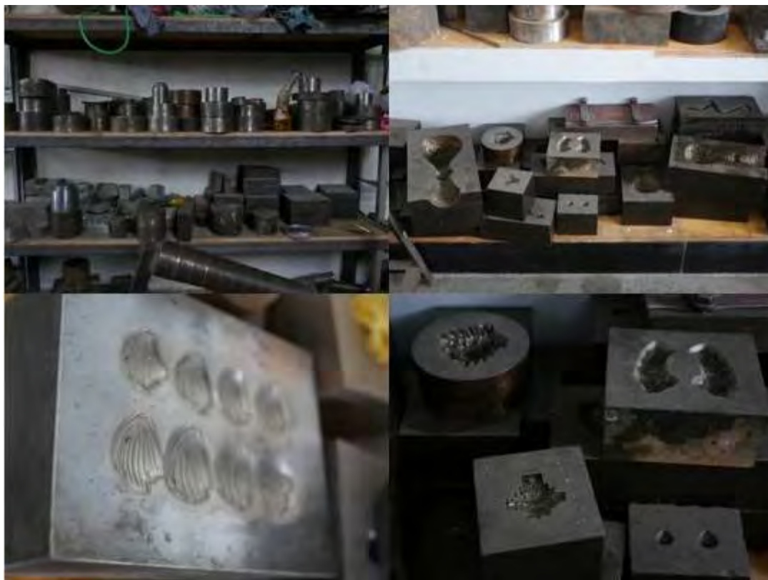
ภาพที่ 2-27 ต้นแบบแม่พิมพ์ (ถ่าย โดย Zhang Linyi, 2017)
