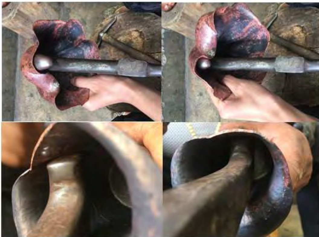
ภาพที่ 4-73 การใช้เครื่องมือตีขึ้นรูปด้านในของภาชนะ (ถ่ายโดย Zhang Linyi, 2018)
