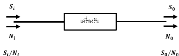
ภาพที่ 2-14 ความสัมพันธ์ของอัตราส่วนระหว่างสัญญาณต่อสัญญาณรบกวนด้านเข้าและด้านออกของเครื่องรับ
