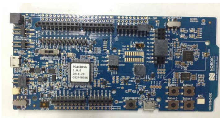
ภาพที่ 3-3 บอร์ด nRF52840-PDK
