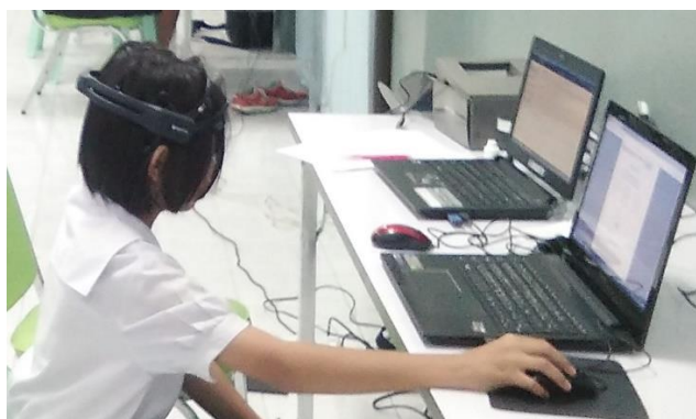
ภาพที่ 3-5 อุปกรณ์ตรวจวัดคลื่นไฟฟ้าสมอง Emotiv EPOC+ และรูปแบบวิธีการสวมใส่
