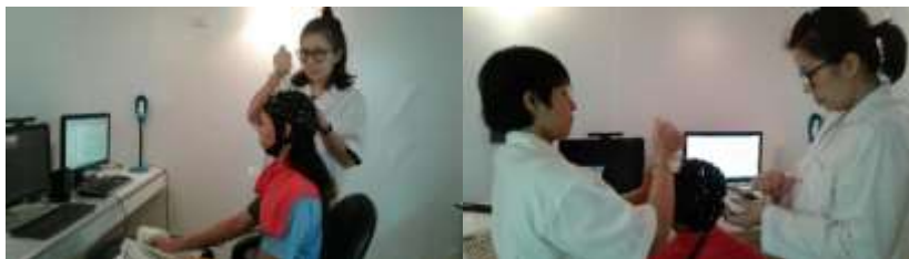
ภาพที่ 3-16 การบรรจุน้ำเกลือสำหรับนำสัญญาณไฟฟ้า
