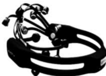
ภาพที่ 2-17 ลักษณะของเครื่องมือวัดคลื่นไฟฟ้าสมองแบบไร้สาย Emotiv EPOC+ ( https://www.emotiv.com/epoc/ )
