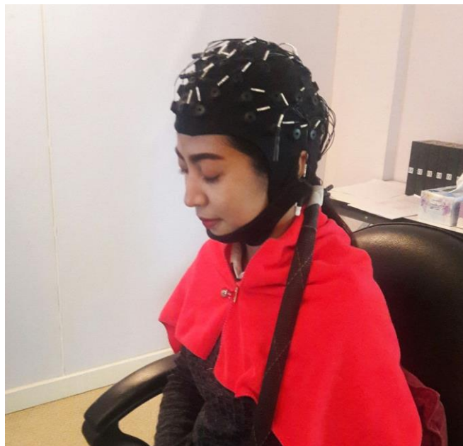
ง-3 หมวกอิเล็กทรอนิกส์ที่อ้างอิงระบบมาตรฐานสากล 10-20 มี 64 ช่องสัญญาณ
