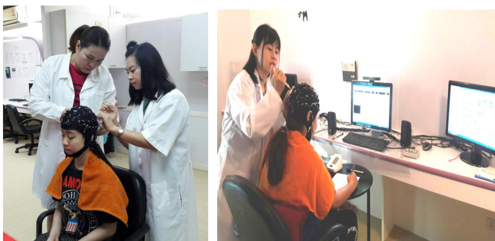
ภาพที่ 3-9 การสวมหมวกอิเล็กโทรด 64 ช่องสัญญาณ
