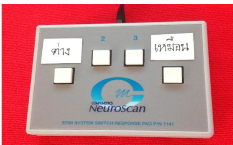
ภาพที่ 3-47 ภาพการประยุกต์อุปกรณ์ STIM System Switch Response Pad ในการทดลอง
