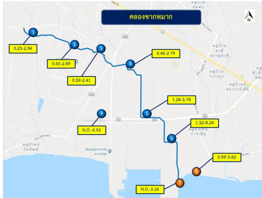
ภาพที่ 4.25 ปริมาณ โครเมียม (VI) ( \mu\text{g/L} ) ในตัวอย่างน้ำผิวดิน (S1-S6 และ S9) และน้ำทะเล (S7-S8) บริเวณคลองซากหมาก เก็บตัวอย่างในช่วง มิ.ย. 59-พ.ค. 60
