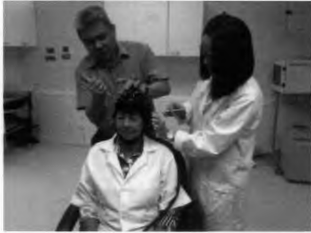
ภาพที่ 3-23 การสวมหมวกที่มีขั้วไฟฟ้า (Electrode) และการบรรจุน้ำเกลือ (Electrolyte) เพื่อนำสัญญาณไฟฟ้า
