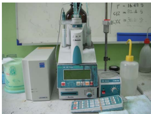
ภาพที่ 3-23 เครื่องไตเตรทอัตโนมัติด้วยวิธีจุดยุติทางศักย์ไฟฟ้า
