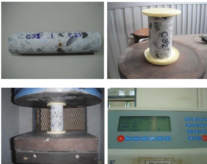
ภาพที่ 3-24 แท่งตัวอย่างที่นำมาทำการทดสอบกำลังอัด
