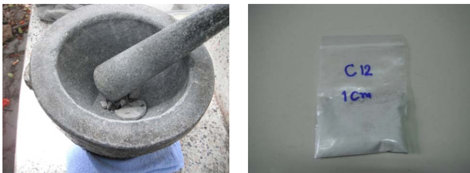
ภาพที่ 3-22 ครกใช้บดตัวอย่างและผงตัวอย่างที่ถูกบดแล้ว
