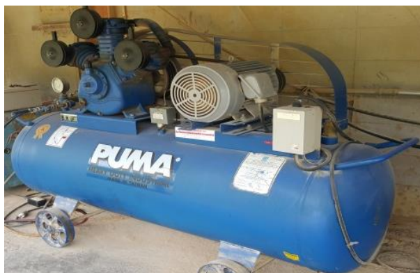
ภาพที่ 4-1 เครื่องอัดอากาศ #1 ยี่ห้อ PUMA ขนาด 10 แรงม้า
