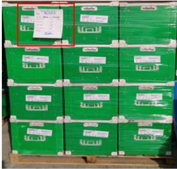
ภาพที่ 4-12 การติดป้ายชี้บ่งการระบอบการจัดส่งและโรงงานลงในแต่ละพาเลท
