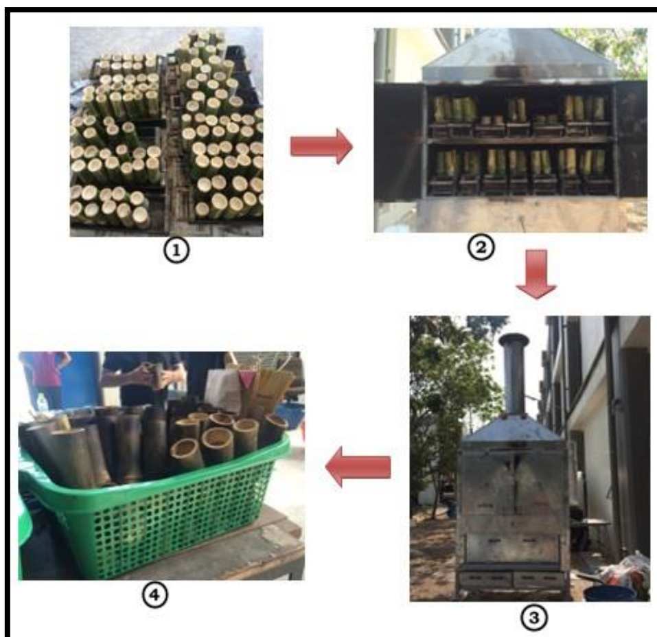
ภาพที่ 3-7 กระบวนการผลิตข้าวหลามหนองมนด้วยเตาเผาข้าวหลามชีวมวล
