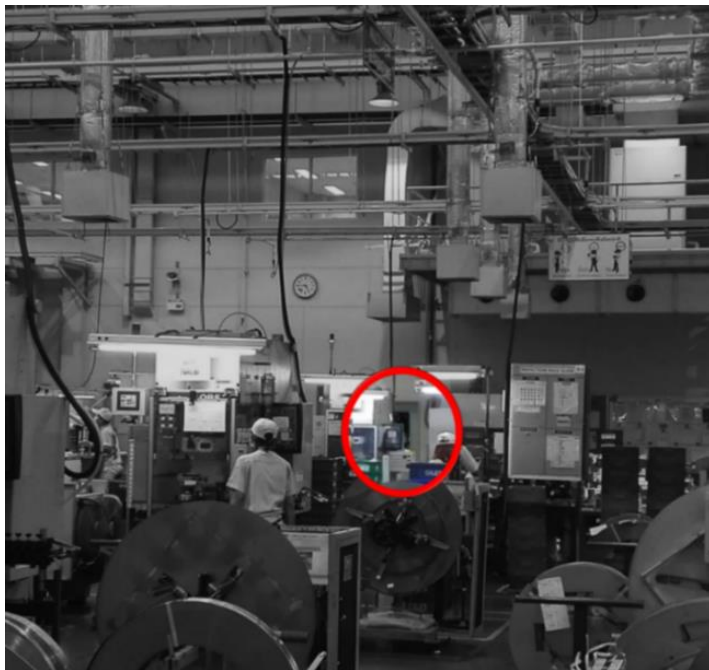
ภาพที่ 4-53 การแสดงสถานะไม่พร้อมใช้งานของห้อง MS โดยการปิดไฟ
