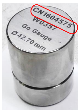
ภาพที่ 4-50 การระบุหมายเลขเครื่องมือวัดด้วยเลเซอร์โดยผู้จัดทำเครื่องมือวัด
