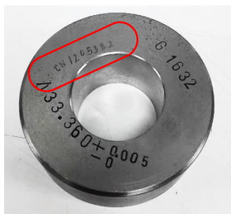
ภาพที่ 4-49 การระบุหมายเลขเครื่องมือวัดด้วยการสลักลงที่เครื่องมือวัด
