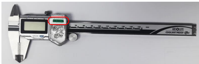
ภาพที่ 4-48 การระบุหมายเลขเครื่องมือวัดด้วยป้ายที่มีความทนทาน
