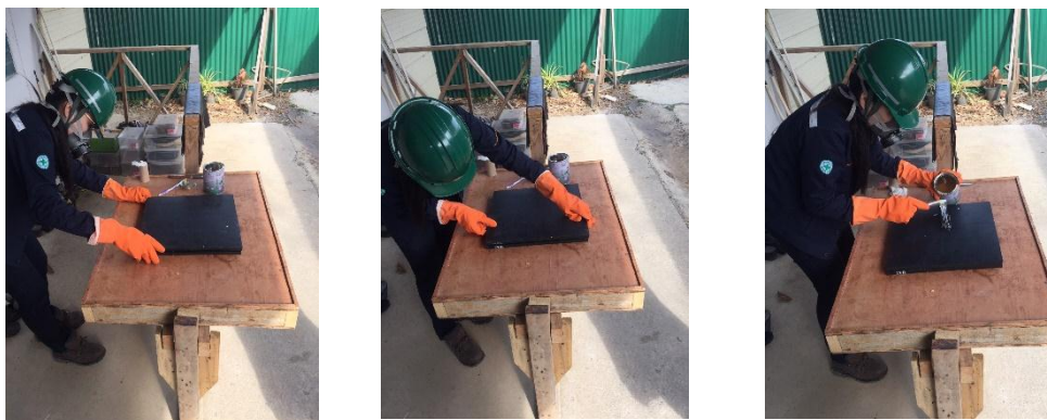
ภาพที่ 3-5 ภาพประกอบเบาะขั้นที่ 2 ด้วยยางไนไตรล์
