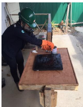
ภาพที่ 3-6 ภาพประกอบเบาะขั้นที่ 3 ด้วยยางบิวไทล์
