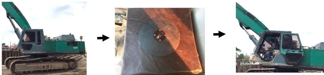
ภาพ 3-8 การตรวจวัดค่าความเร่งของแรงสั่นสะเทือนหลังการใช้เบาะรองนั่ง
