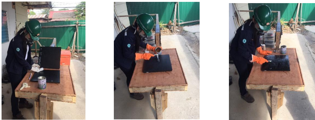
ภาพที่ 3-4 ภาพประกอบเบาะขั้นที่ 1 ด้วยยางธรรมชาติ
