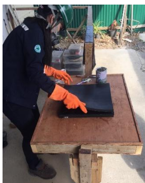
ภาพที่ 3-6 ภาพประกอบเบาะขั้นที่ 3 ด้วยยางบิวไทล์
