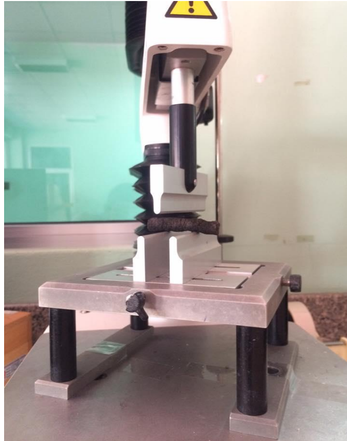
ภาพภาคผนวก ข-1 ตัวอย่างการวิเคราะห์ค่าความแข็ง (hardness) และ ค่าความแตกเปราะ (fractulability) ด้วยหัววัด HDP/3PB
