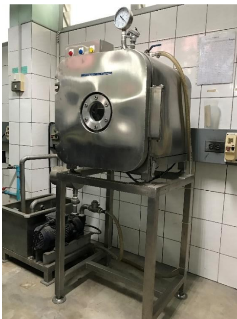
ภาพที่ 2-5 ลักษณะเครื่องอบแห้งแบบสุญญากาศ
