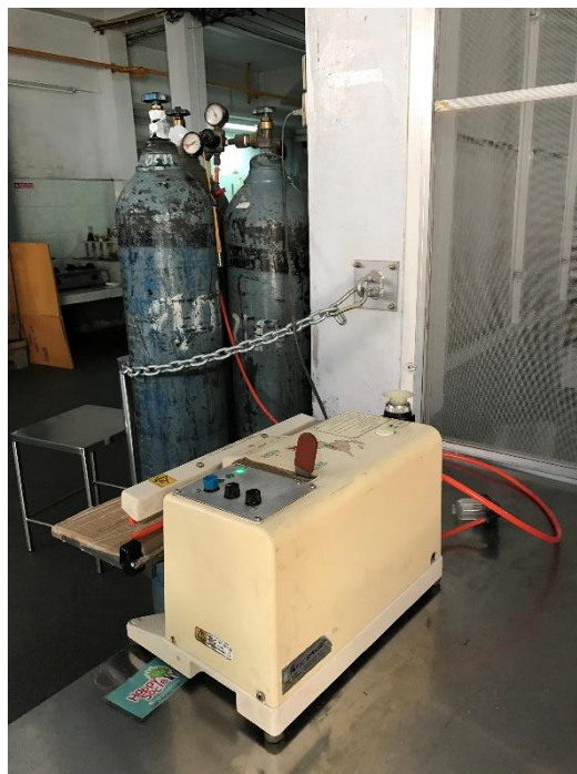
ภาพภาคผนวก ช-3 ลักษณะและเครื่องมือการบรรจุและปิดผนึกขนมขบเคี้ยวแบบปรับสภาพ บรรยากาศโดยฟันท้าไนโตรเจนร้อยละ 99.99
