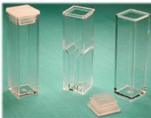
ภาพที่ 2-6 แสดงเซลล์ในสารตัวอย่างของเครื่องยูวี-วิสิเบิล สเปกโทรโฟโตมิเตอร์ (ภิญโญ พานิชพันธ์, ม.ป.ป.)
