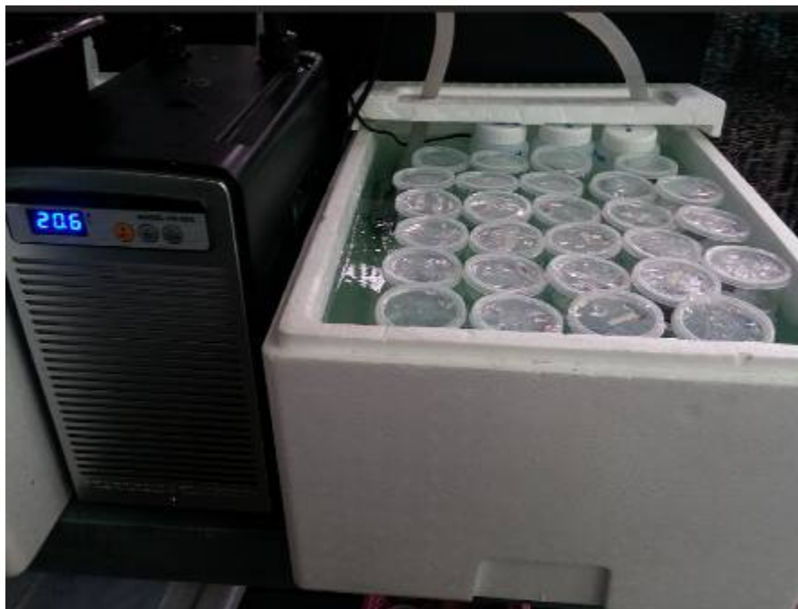
ภาคผนวก ข - 7 รูปแบบการใช้เครื่องควบคุมอุณหภูมิน้ำที่ต่อกับกล่องโฟม
