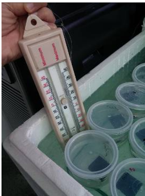
ภาคผนวก ข - 9 เครื่องวัดอุณหภูมิ (เทอร์โมมิเตอร์ชนิดวัดค่าสูงสุด - ต่ำสุด ในรอบวัน) ที่ใช้วัดอุณหภูมิระหว่างการทดลอง
