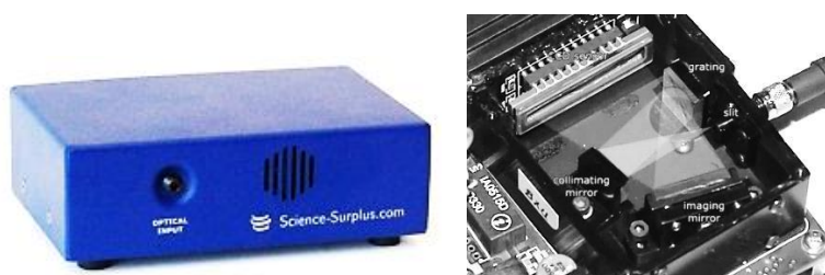
ภาพที่ 2-9 สเปกโตรมิเตอร์ Science-Surplus รุ่น BTC-110S
