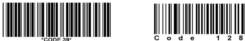
ภาพที่ 2.2 แสดงตัวอย่างของบาร์โค้ด 1 มิติที่ใช้งานได้ทั้งตัวเลขและตัวอักษร
