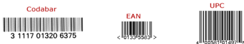
ภาพที่ 2.1 แสดงตัวอย่างของบาร์โค้ด 1 มิติที่ใช้งานได้เฉพาะตัวเลข
