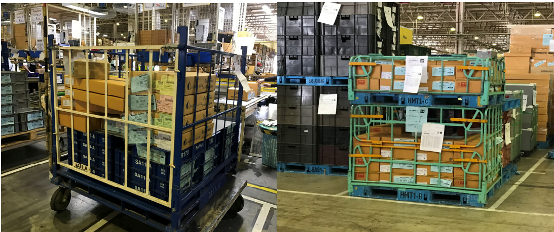
ภาพที่ 5-3 ตัวอย่างแนวทางการไคเซนก่อนและหลังของการเพิ่มประสิทธิภาพการบรรจุสินค้าบนรถขนส่งโดยวิธีการไคเซนแบบทำตะแกรงใส่สินค้า ของบริษัท AAA Logistics จำกัด
