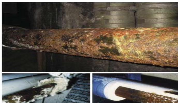
ภาพที่ 1-3 ปัญหาการกัดกร่อนของท่อในอุตสาหกรรมก๊าซและน้ำมัน (Amrcell Engineering Ing., 2016)
