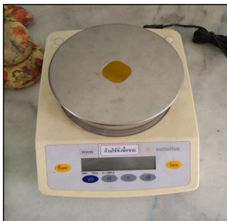
ภาพที่ 3.2 เครื่องชั่งน้ำหนักแบบดิจิตอลยี่ห้อ Sartorius รุ่น TE 3102S ที่มีความละเอียด \pm 0.01 กรัม
