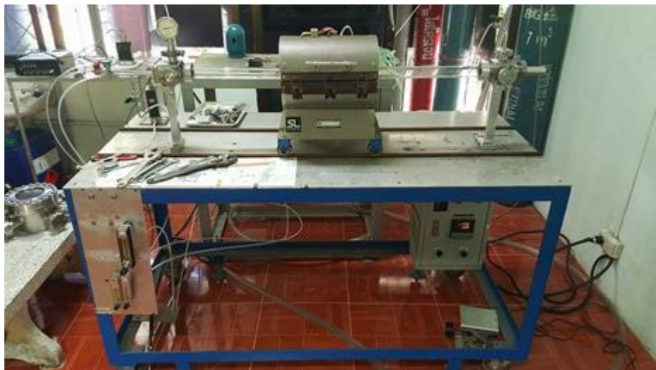
ภาพที่ 23 แสดงรูประบบ CVD ที่ใช้ในการสังเคราะห์ท่อนาโนคาร์บอน
