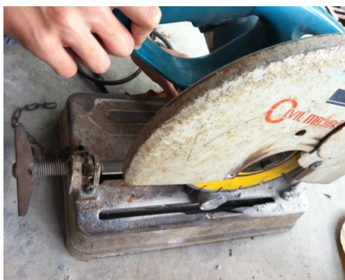
ภาพที่ 3-5 ตัดตัวอย่างคอนกรีตทรงกระบอกหนาชั้นละ 10 มม.
