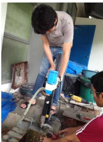
ภาพที่ 3-4 การเจาะตัวอย่างคอนกรีตให้มีลักษณะเป็นทรงกระบอกขนาด 50 x 200 มม 2
