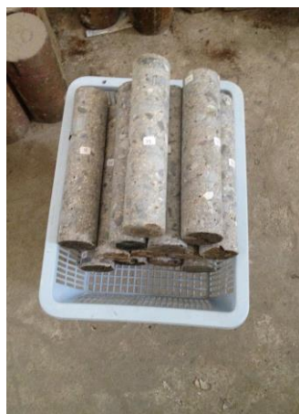
ภาพที่ 3-4 การเจาะตัวอย่างคอนกรีตให้มีลักษณะเป็นทรงกระบอกขนาด 50 x 200 มม 2
