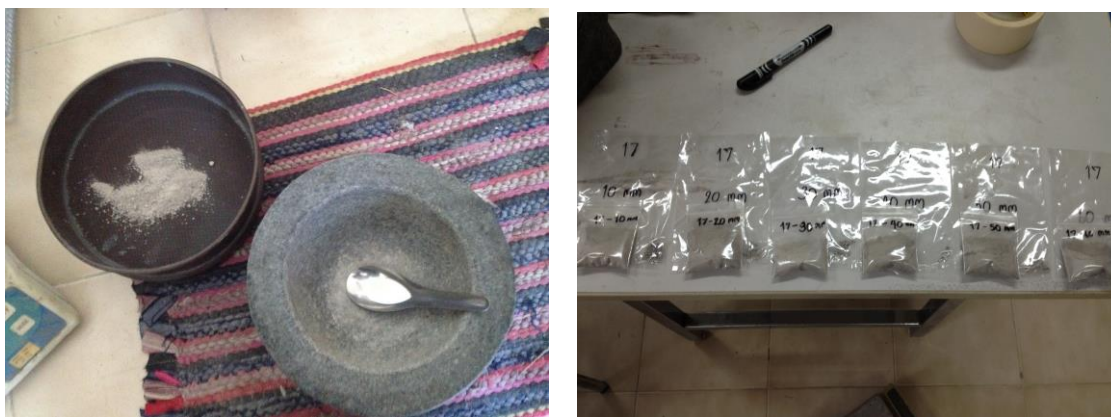
ภาพที่ 3-6 การบดตัวอย่างเพื่อทดสอบคลอไรด์
