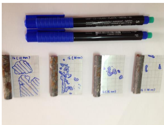
ภาพที่ 3-7 การวัดพื้นที่การเกิดสนิมในเหล็กโดยใช้กระดาษกราฟใส
