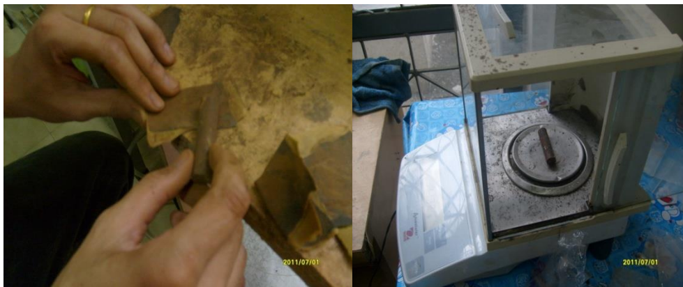
ภาพที่ 3-8 วัดการสูญเสียน้ำหนักของสนิมในเหล็กเสริม
