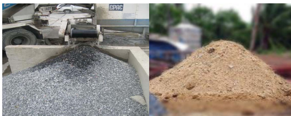
ภาพที่ 2-2 การคัดแยกวัสดุบดออกจากคอนกรีตสด
