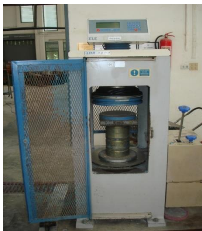
ภาพที่ 3-9 เครื่องทดสอบกำลังอัดคอนกรีตยี่ห้อ ELE
