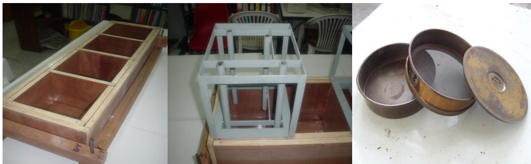
(ค) แบบหล่อตัวอย่างคอนกรีต (ง) แบบฝังเหล็กลงในคอนกรีต (จ) ตะแกรงร้อนมาตรฐาน
