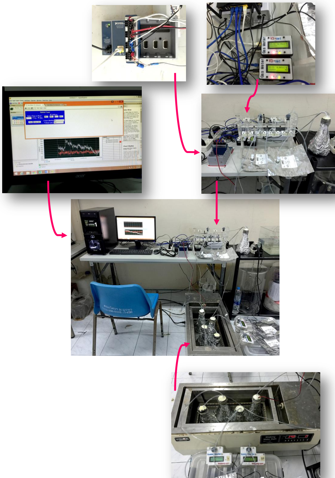
ภาพที่ 3-16 การทดลองผลิตก๊าซชีวภาพจากตะกอนเลนบ่อเลี้ยงกุ้งโดยการหมักแบบไม่ใช้แสงและออกซิเจน
