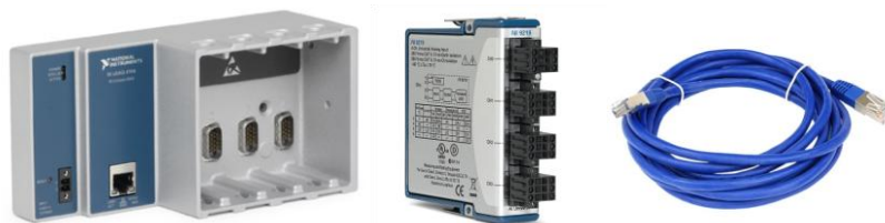
ภาพที่ 3-2 Compact DAQ Chassis, Universal Analog Input module และสายแลน
