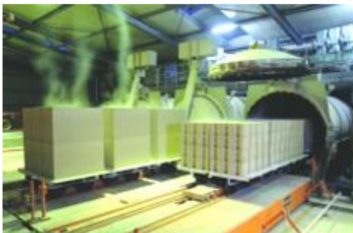
ภาพที่ 2-6 กระบวนการอบไอน้ำแรงดันสูง (บริษัท ควอลิตี้คอนสตรัคชันโปรดักส์ จำกัด (มหาชน), (ม.ป.ป.))
