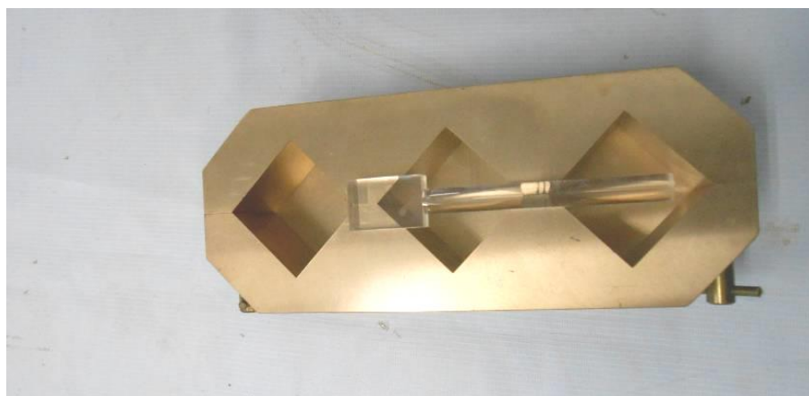
ภาพที่ 3-13 แบบหล่อมอร์ตาร์มาตรฐานขนาด 5 x 5 x 5 เซนติเมตร
