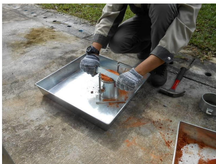
ภาพที่ 3-9 ใช้บรรทัดเหล็กปาดดินส่วนที่สูงเกินปากโมลออก
