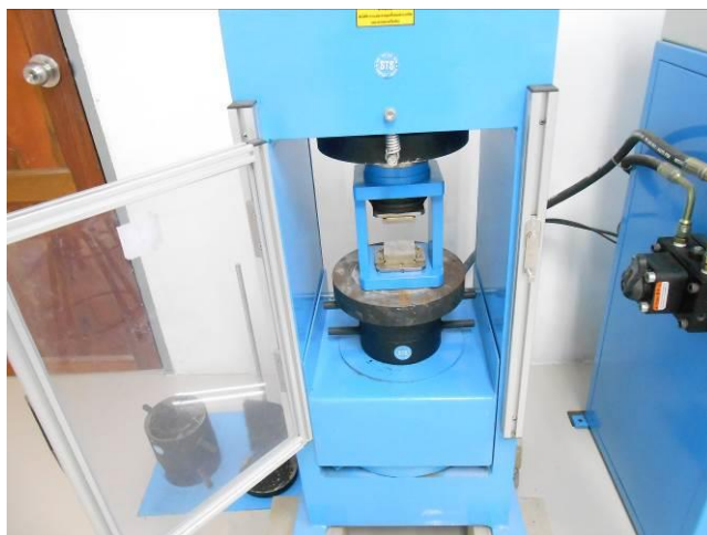
ภาพที่ 3-22 ประกอบแท่นกดมอร์ตาร์กับเครื่องทดสอบกำลัง
