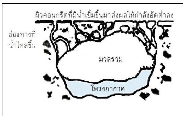
ภาพที่ 2-4 โพรงอากาศจากการเยิ้มของคอนกรีต (บริษัท เครือซีเมนต์ไทย จำกัด (มหาชน), 2548)
