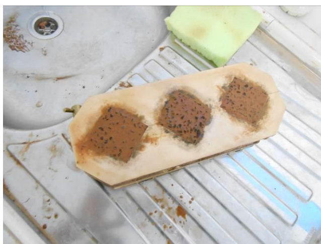
ภาพที่ 3-20 ใช้ฟองน้ำชุบน้ำเช็ดผิวด้านบนของแบบหล่อ
