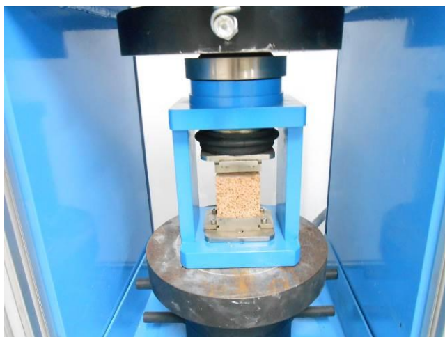
ภาพที่ 3-24 นำอิฐวางในแท่นกดมอร์ตาร์
