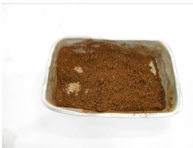
ภาพที่ 3-17 เติมน้ำลงไปคลุกเคล้าส่วนผสมให้เข้ากัน
