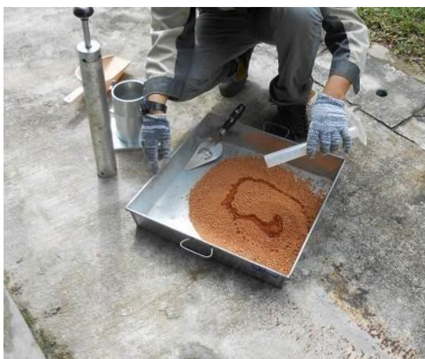
ภาพที่ 3-7 การนำน้ำผสมในดินตัวอย่าง
