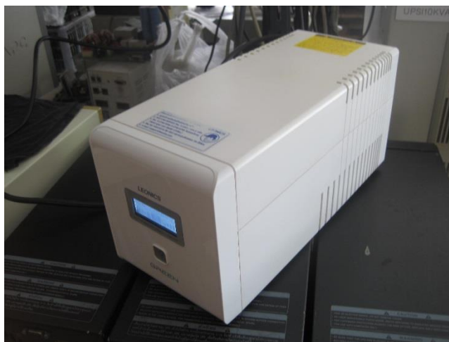
ภาพที่ 3-18 UPS Leonics รุ่น Green-1000VA 600 watt
