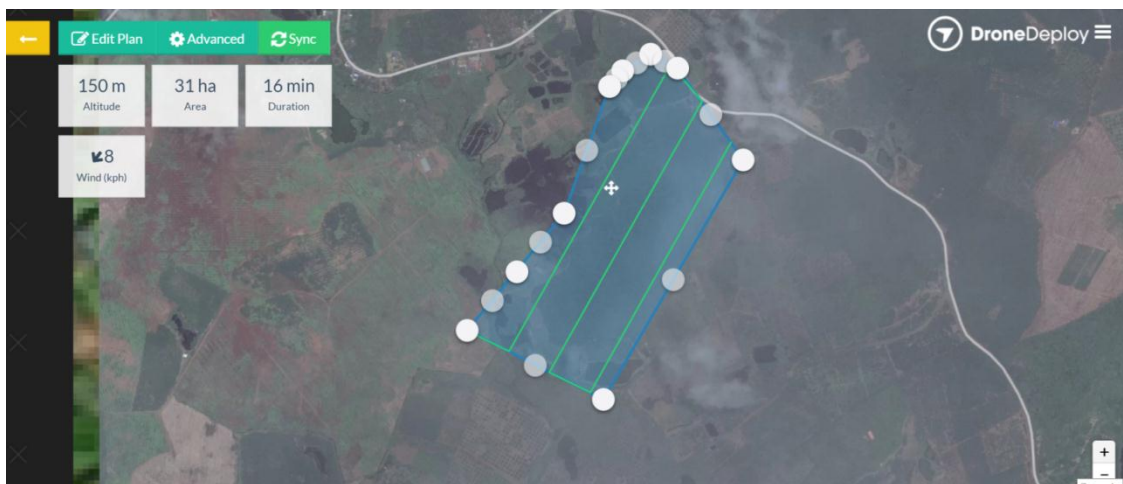
ภาพที่ 3-5 ตัวอย่างการวางแผนการบิน (ที่มา : www.dronedeploy.com )
