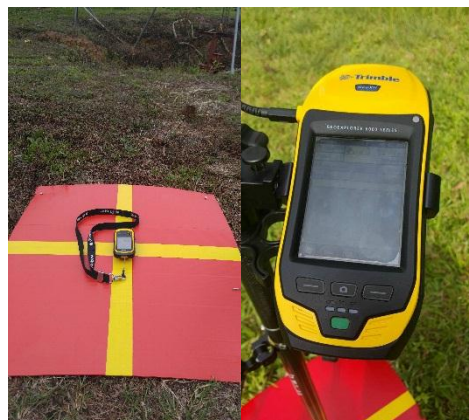
รูปที่ 3-6 การกำหนดจุดควบคุมภาคพื้นดิน (Ground Control Point) และจุดอ้างอิงตามธรรมชาติ
