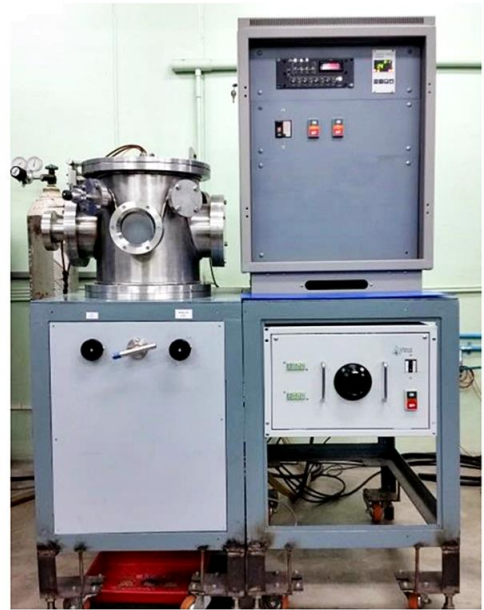
ภาพที่ 3-1 ไตอะแกรมและลักษณะของเครื่องเคลือบสุญญากาศระบบแมกนีตรอนสปัตเตอร์ริง
