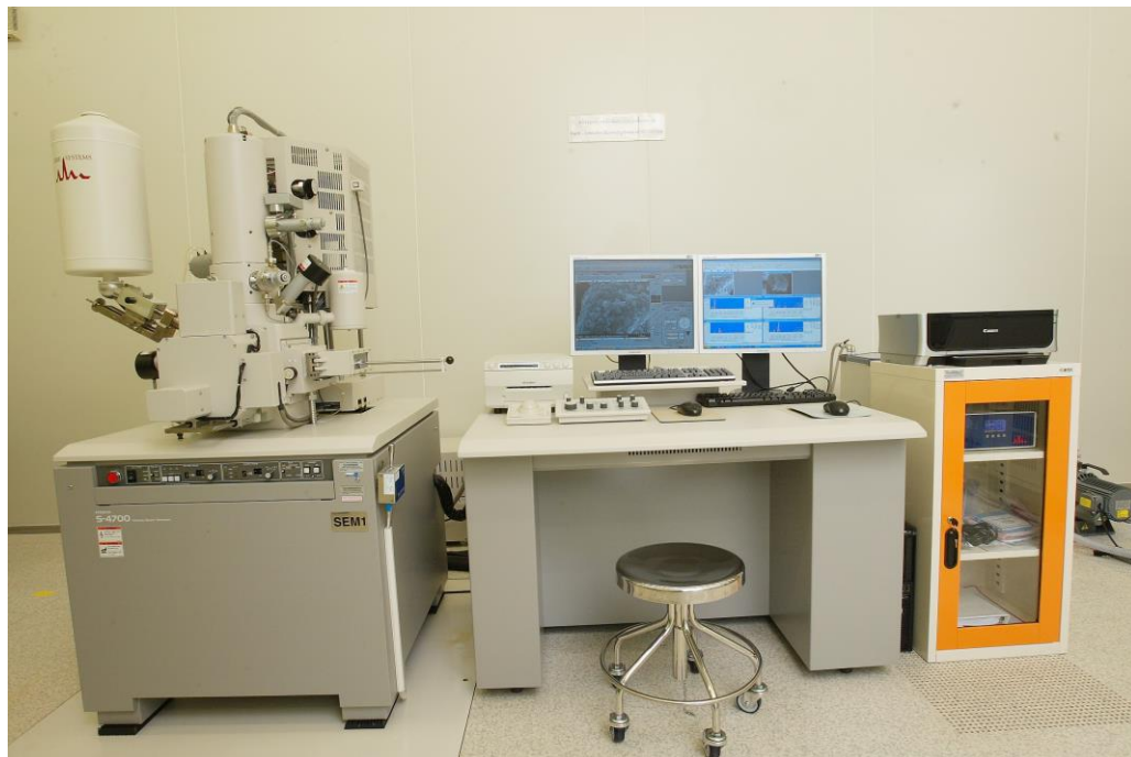
ภาพที่ 3-3 เครื่อง Field Emission Scanning Electron Microscope (FE-SEM) พร้อม Energy Dispersive X-ray Spectroscopy (EDS)
