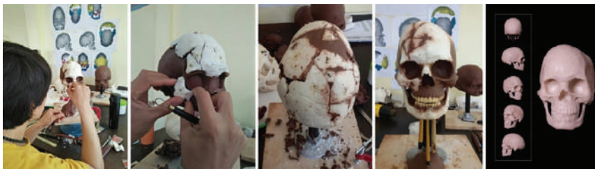
ภาพที่ 5: ขณะประกอบชิ้นส่วนกระดูกกะโหลกเรซิน และกะโหลกที่ผ่านการหล่อด้วยวัสดุเรซินเรียบร้อยแล้ว
