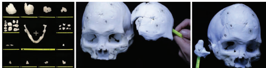
ภาพที่ 4: ชิ้นส่วนกระดูกกะโหลกที่ได้จากการพิมพ์ 3 มิติ ด้วยวัสดุเรซิน
