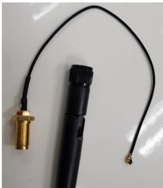
ภาพที่ 2 - 14 หัวเชื่อมต่อแบบ IPEX สำหรับเสาสัญญาณย่านความถี่ 2.4GHz ที่ใช้กับอุปกรณ์ ESP32 (ESP32-wroom-32D)
