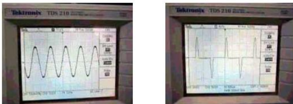
ภาพที่ 2 - 10 คุณสมบัติของการใช้กระแสไฟฟ้าของ Linear load (หลอดไส้) และ Non-linear load (คอมพิวเตอร์) (ที่มา Leonics Co., Ltd.)
