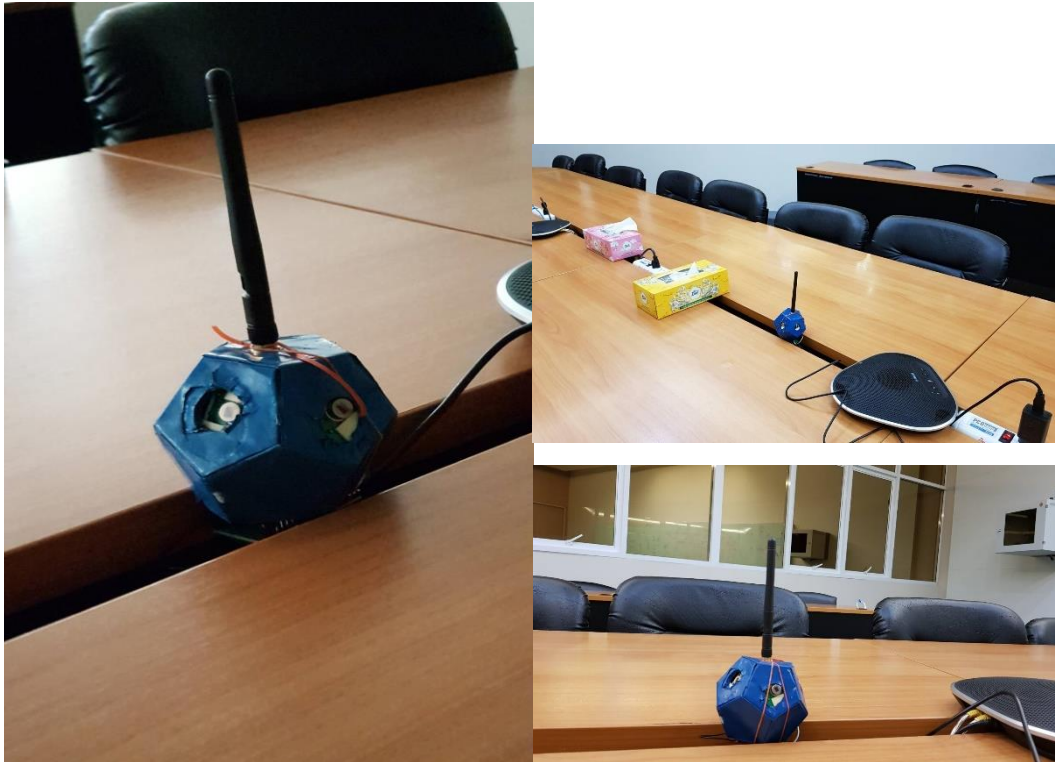
ภาพที่ 3 - 1 แสดงอุปกรณ์เซ็นเซอร์ตรวจจับความเคลื่อนไหวที่ถูกออกแบบให้ตั้งไว้บริเวณโต๊ะ
