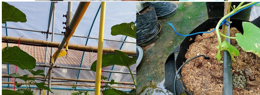
ภาพที่ 12 การเก็บข้อมูลความชื้นดิน ความชื้นสัมพัทธ์ และอุณหภูมิ ภายในโรงเรือน
