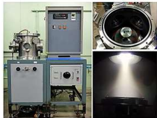
ภาพที่ 3-2 เครื่องเคลือบระบบสปิดเตอริงที่ใช้เคลือบในงานวิจัย
